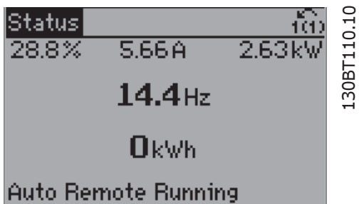
图 2.7: 步骤 1: 打开变频器 (黄色指示灯亮起)
