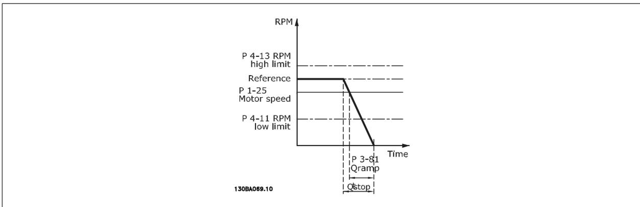
$$Par.. 3 - 81 = \frac{t_{Qstop} [s] \times n_s [tr/min]}{\Delta Jogging \text{ réf } (par.. 3 - 19) [tr/min]}$$
