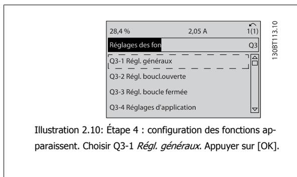
Illustration 2.10: Étape 4 : configuration des fonctions apparaît. Choisir Q3-1 *Régl. généraux*. Appuyer sur [OK].
