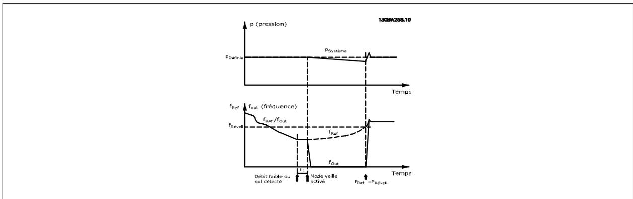
Lors d'une détection de faible puissance ou de vitesse basse, le moteur est arrêté, mais le signal de référence ( $f_{réf}$ ) émis par le contrôleur externe est toujours sous surveillance, et en raison de la basse pression générée, le contrôleur augmente le signal de référence pour gagner en pression. Une fois que le signal de référence a atteint une valeur définie  $f_{réveil}$ , le moteur redémarre.
