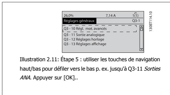
Illustration 2.11: Étape 5 : utiliser les touches de navigation haut/bas pour défiler vers le bas p. ex. jusqu'à Q3-11 *Sorties ANA*. Appuyer sur [OK].
