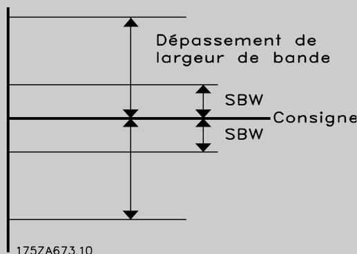
Le réglage de l'OBW trop près de la SBW pourrait être préjudiciable au but en raison de démarrages fréquents en cas de changements de pression momentanés. Un réglage de l'OBW trop élevé peut entraîner une pression élevée ou basse inacceptable pour le système alors que les temporisateurs SBW fonctionnent. La valeur peut être optimisée quand on est plus familiarisé avec le système. Voir le Par. 25-25 *Tps OBW*.
