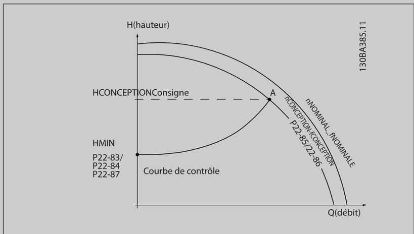
À partir de la fiche technique indiquant les caractéristiques à différentes vitesses de l'équipement concerné, la lecture simple des points  $H_{\text{FONCTIONNEMENT}}$  et  $Q_{\text{FONCTIONNEMENT}}$  permet de trouver le point A qui est le point de travail de fonctionnement du système. Les caractéristiques de la pompe à ce
