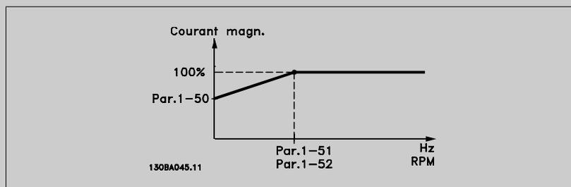
**1-51 Magnétis. normale vitesse min [tr/min]****Range:**Application [10 - 300 RPM]
