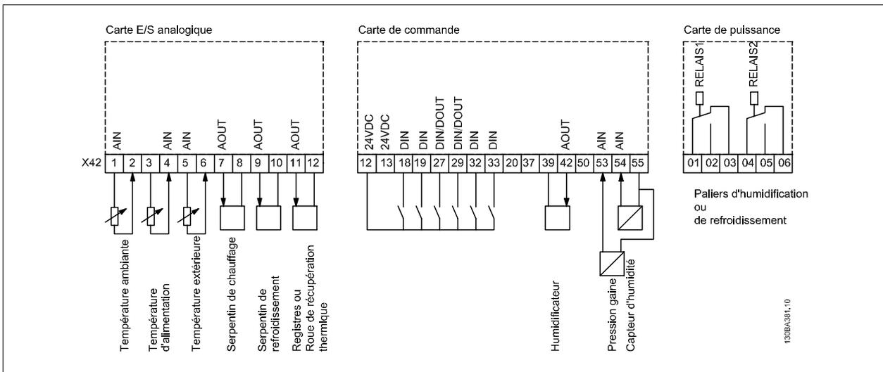
Il montre un groupe de traitement d'air typique (AHU). Comme on peut le voir, l'ajout d'une option d'E/S analogiques permet de contrôler toutes les fonctions depuis le variateur de fréquence, p. ex. clapets d'entrée, de retour et d'évacuation ou bobines de chauffage/refroidissement avec des mesures de température et de pression qui s'affichent sur le variateur de fréquence.
