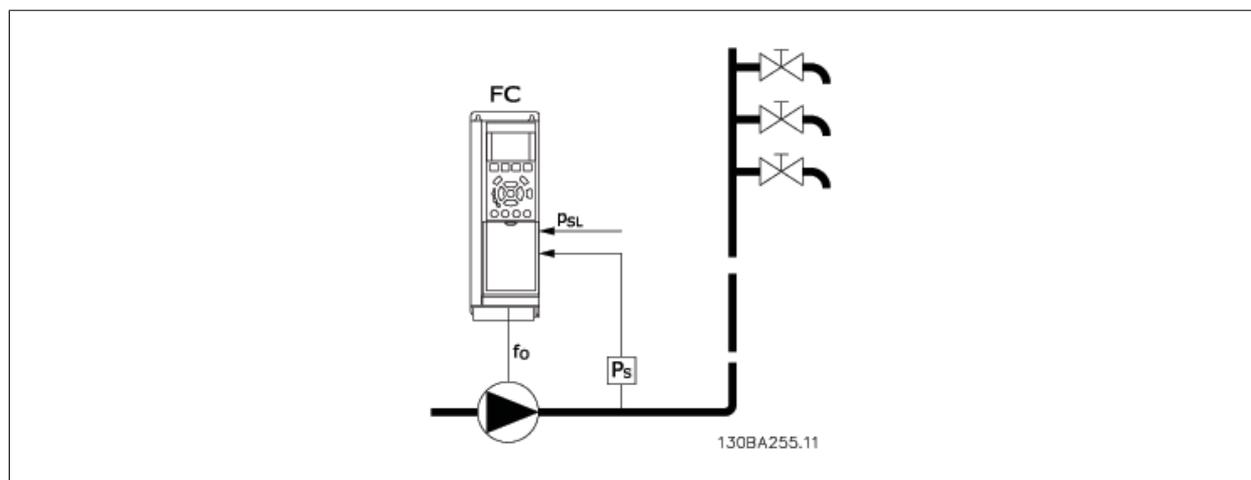
1) Les systèmes où le régulateur PI intégré permet de contrôler la pression ou la température, par exemple, les systèmes de suralimentation avec un signal de retour de pression appliqué au variateur de fréquence par un capteur de pression. Le Par. 1-00 *Mode Config.* doit être défini sur Boucle fermée et le régulateur PI configuré pour les signaux de référence et de retour souhaités.
