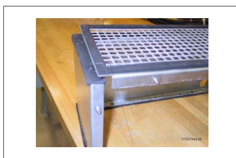
Afbeelding 3.41: De pakking vouwt zich over de rand heen om te zorgen voor een afdichting tussen het luchtkanaal en de bovenafdekking met ventilatierooster.
