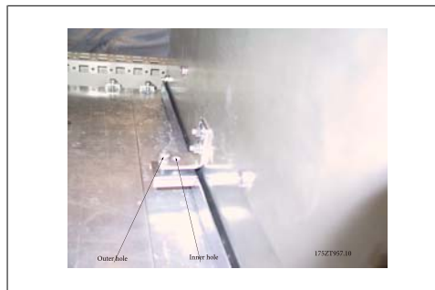
Afbeelding 3.58: Verplaats de bevestigingsschroeven van de buitenste naar de binnenste gaten
