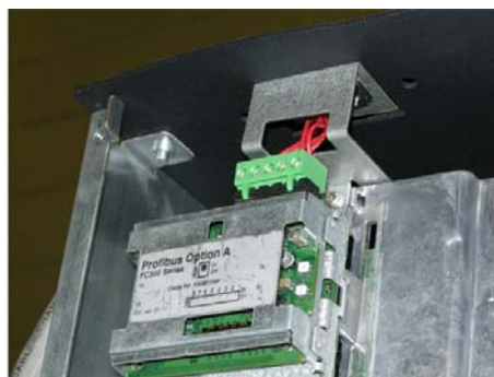
Afbeelding 4.17: Boven aansluiting voor veldbus
