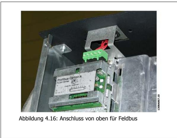
Abbildung 4.16: Anschluss von oben für Feldbus
