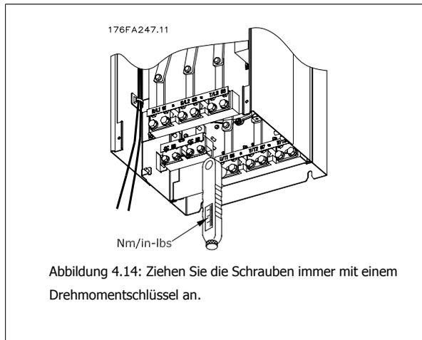
Abbildung 4.14: Ziehen Sie die Schrauben immer mit einem Drehmomentschlüssel an.
