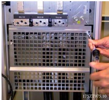
Ilustración 4.15: Instalación del apantallamiento EMC.
