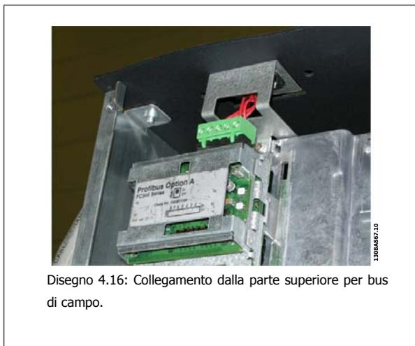
Disegno 4.16: Collegamento dalla parte superiore per bus di campo.
