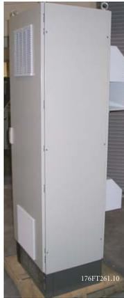
본 절은 주파수 변환기 프레임 D3, D4 및 E2 에 사용할 수 있는 NEMA 3R 키트 설치에 관한 내용입니다. 이 키트는 Rittal TS8 NEMA 3R 또는 NEMA 4 외함에 설치되어 있는 이 프레임의 IP00/ 새시 버전에 사용하도록 설계되었으며 시험을 거쳤습니다. NEMA-3R 외함은 강설에 대한 보호 수준을 제공하는 야외용 외함입니다. NEMA-4 외함은 기후 및 물호스에 대해 보다 우수한 보호 수준을 제공하는 야외용 외함입니다. 외함의 최소 깊이는 500mm (E2 프레임의 경우, 600mm)이며 키트는 600mm (E2 프레임의 경우, 800mm) 와이드형 외함에 사용하도록 설계되어 있습니다. 외함의 너비를 늘릴 수는 있으나 그렇게 하기 위해서는 Rittal 하드웨어가 추가로 필요합니다. 설치 시 필요에 따라 최대 깊이 및 너비가 사용될 수 있습니다.
