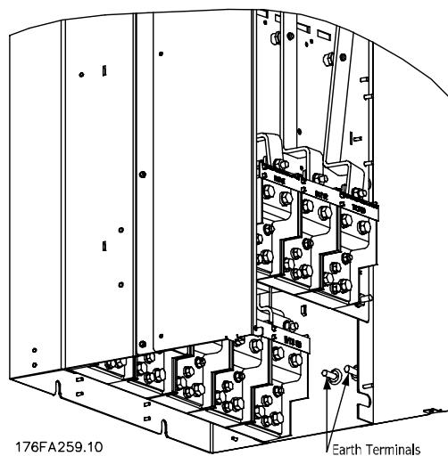
图 4.9: IP00, 机架规格 E 的接地端子的位置
