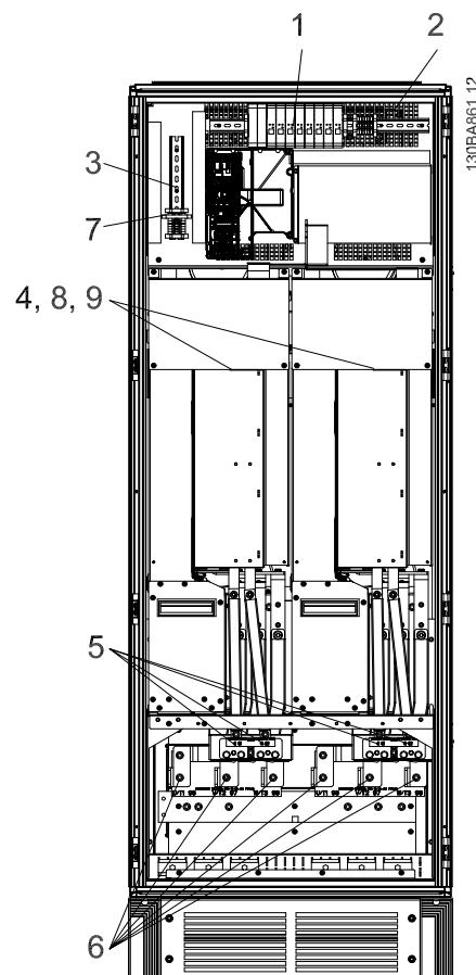
图 4.11：逆变器机柜，机架规格 F1 和 F3
