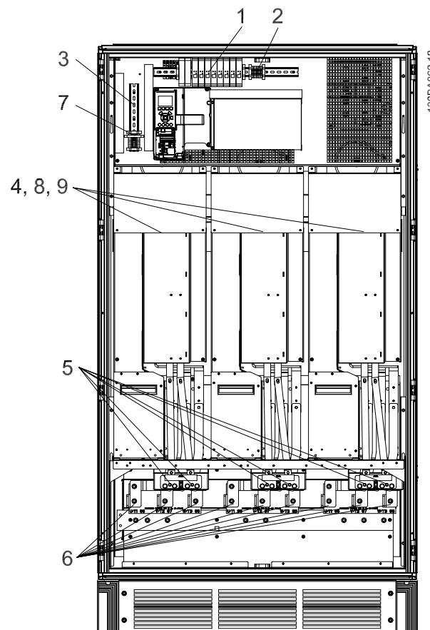
图 4.12：逆变器机柜，机架规格 F2 和 F4
