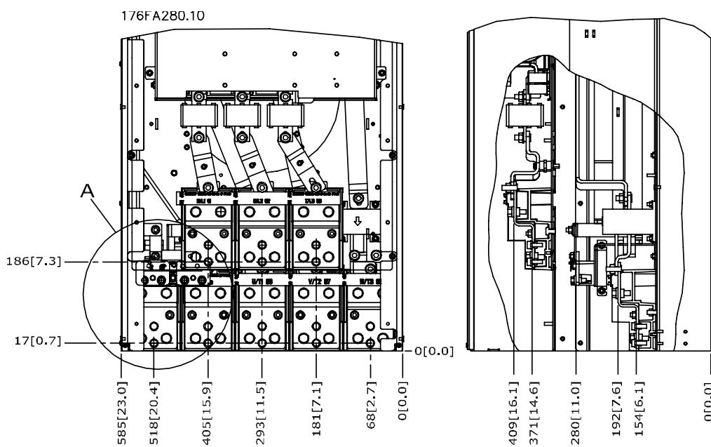
图 3.19: IP00 机箱 的电源接头位置
