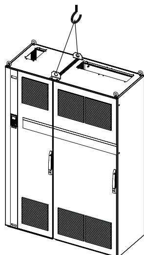
图 3.4: 建议起吊方法, 机架规格 F1。
