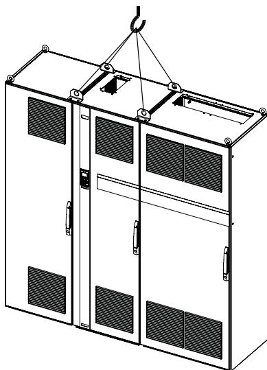
图 3.6: 建议起吊方法, 机架规格 F3。
