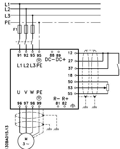
图 3.1：此图显示了基本安装，其中包括主电源、电动机、启动/停止键以及用于调整速度的电位计。
