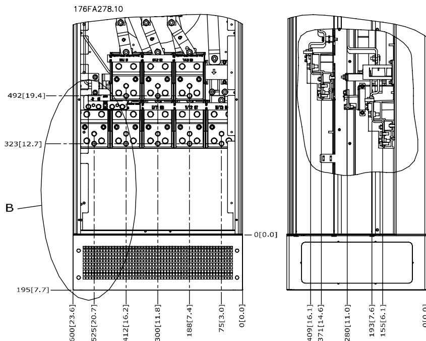
图 3.16: IP21 (NEMA 类型 1) 和 IP54 (NEMA 类型 12) 机箱的电源接头位置
