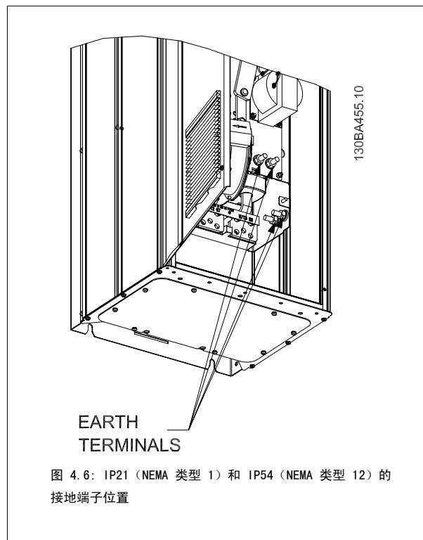
图 4.6: IP21 (NEMA 类型 1) 和 IP54 (NEMA 类型 12) 的接地端子位置
