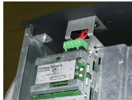
图 4.16：从顶部连接现场总线。
