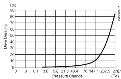
图 3.31: E 机架 的降容与 压力变化 (小风扇), P315T5 和 P450T7-P500T7
