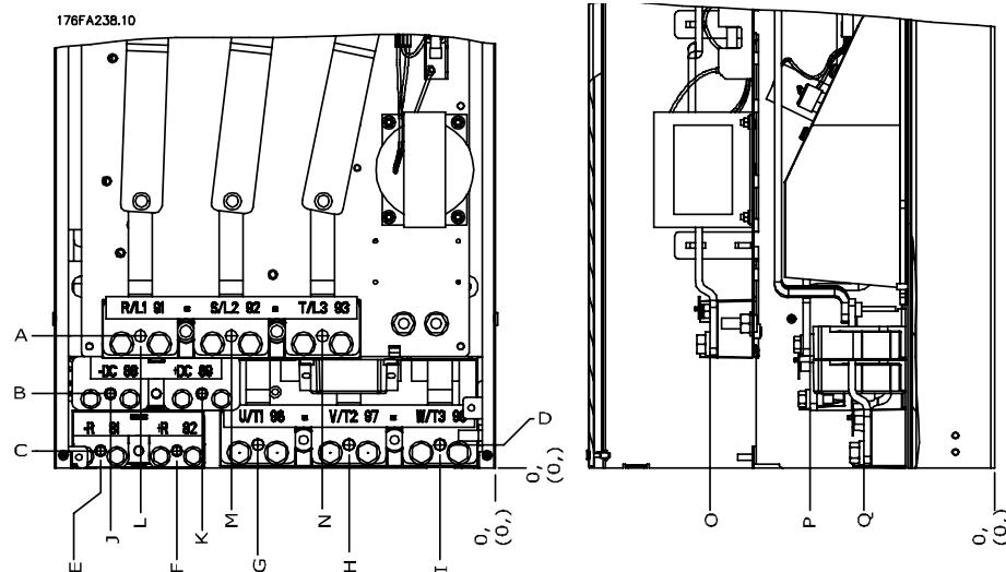
图 3.14: 电源连接的位置, 机架规格 D3 和 D4
