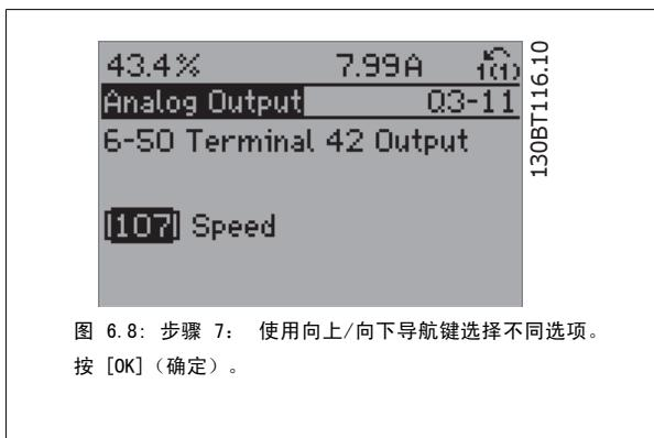
图 6.8：步骤 7： 使用向上/向下导航键选择不同选项。
