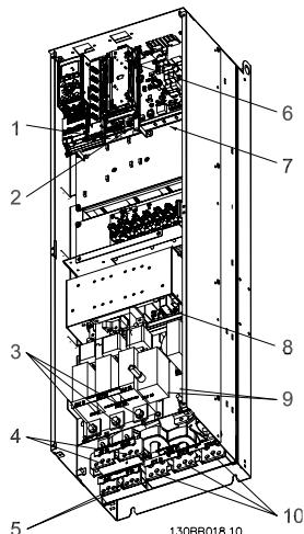
图 4.4: 紧凑型 IP 00 (机架式), 带断路器、保险装置和射频干扰滤波器, 机架规格 D4
