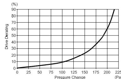
图 3.33: F1、F2、F3、F4 机架 的降容与 压力变化
