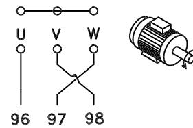
更换电动机电缆的两个相或更改 参数 4-10 电动机速度方向 的设置可改变其旋转方向。
