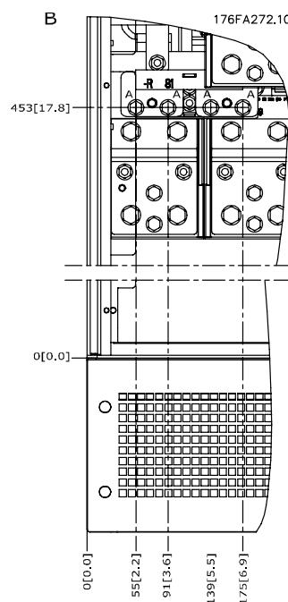
图 3.17: IP21 (NEMA 类型 1) 和 IP54 (NEMA 类型 12) 机箱的电源接头位置 (B 处的局部视图)
