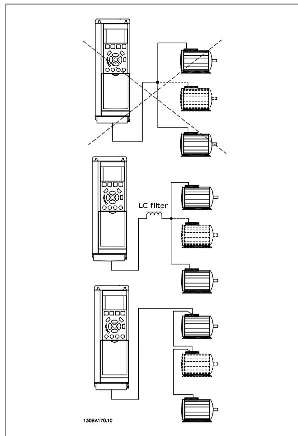
如果电动机的规格相差较大，在启动和 RPM 值低时可能引发问题。原因是，小型电动机的定子欧姆电阻相对较高，它在启动和 RPM 值低时会要求较高的电压。
