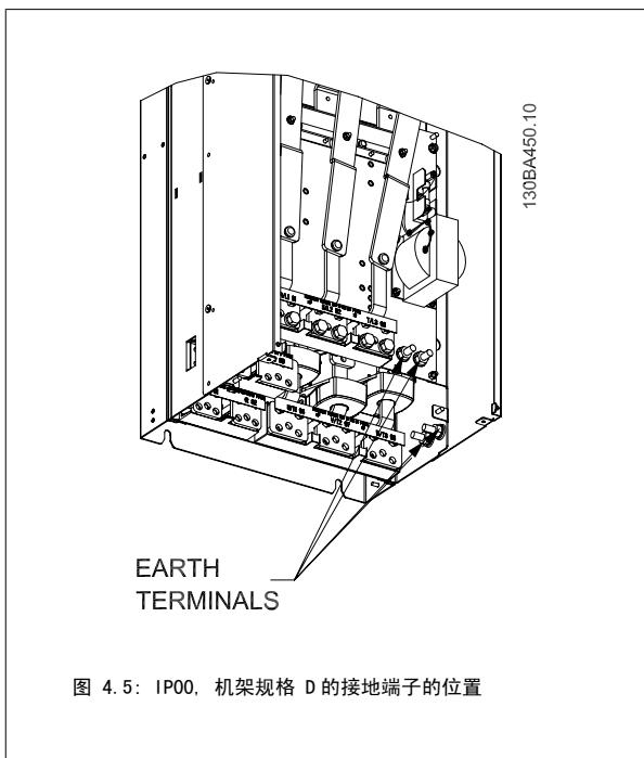
图 4.5: IP00, 机架规格 D 的接地端子的位置
