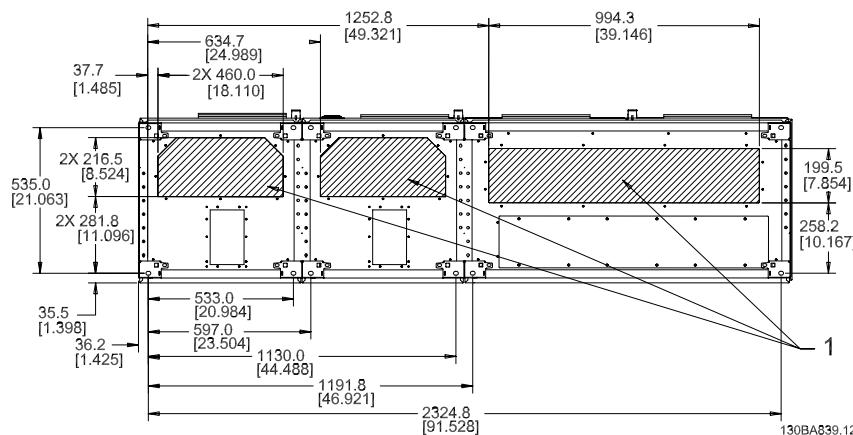
F1-F4: 电缆入口（从变频器底部看 - 1） - 将线管放到所标明的区域
