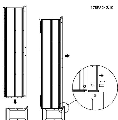
图 3.40：将变频器安装到底座上。
