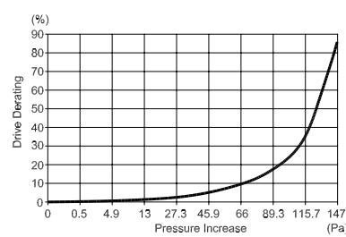
图 3.30: D 机架 的降容与 压力变化
