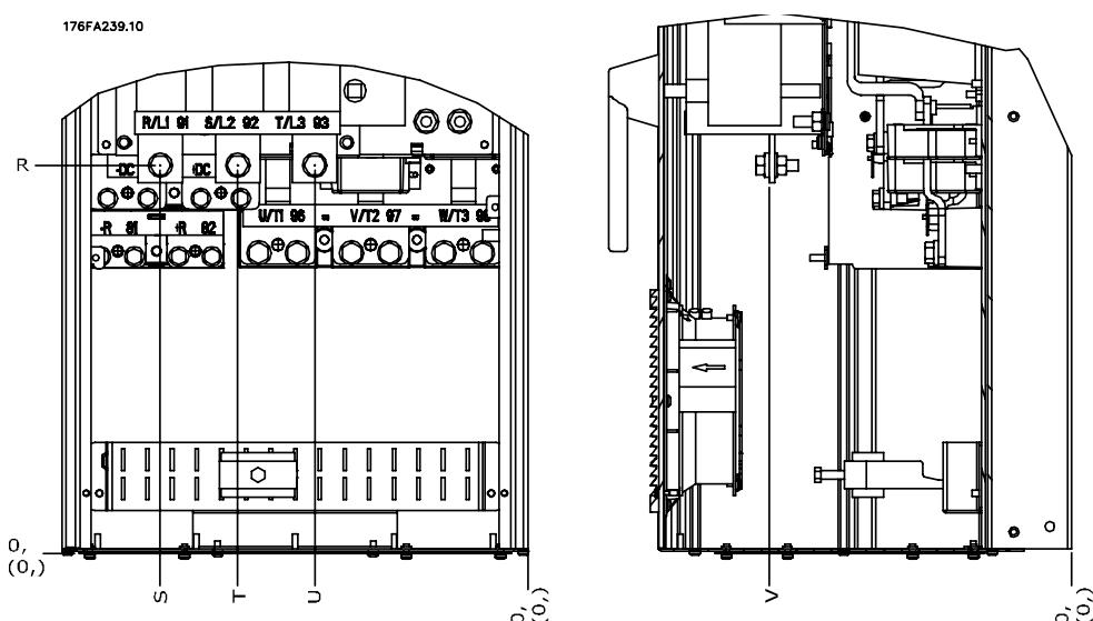
图 3.15: 电源连接 (带断路开关) 的位置, 机架规格 D1 和 D2
