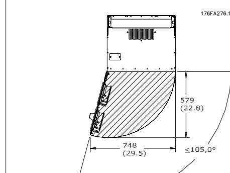
图 3.9: IP21/IP54 机箱类型, 机架规格 E1 的前方空间。
