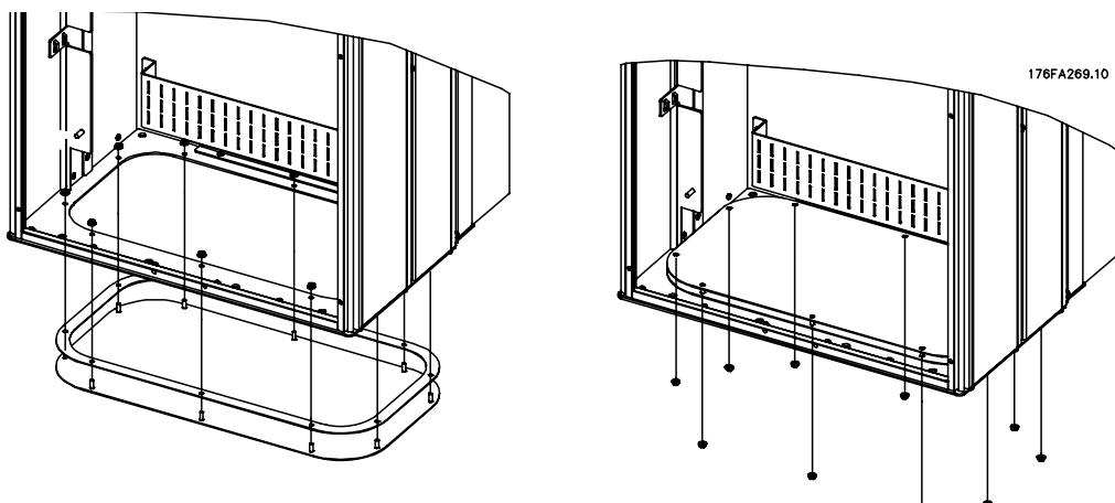
图 3.36：底板安装，机架规格 E1。
