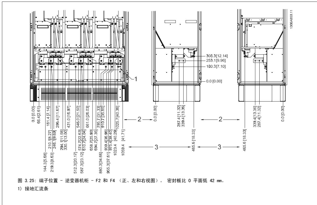
图 3.25: 端子位置 - 逆变器机柜 - F2 和 F4 (正、左和右视图)。密封板比 0 平面低 42 mm。
