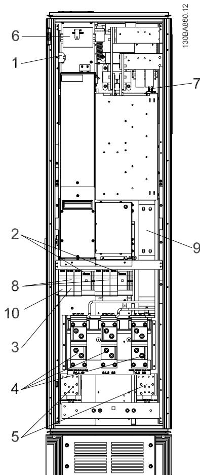
图 4.10: 整流器机柜, 机架规格 F1、F2、F3 和 F4
