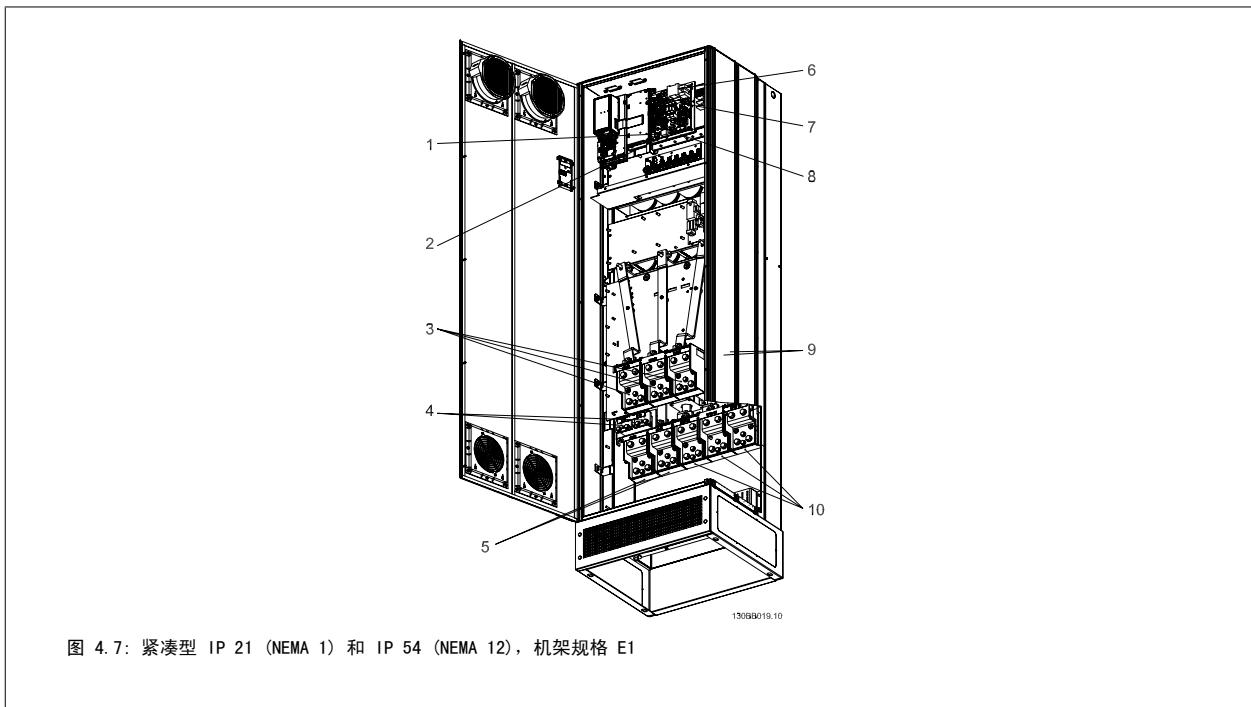
图 4.7: 紧凑型 IP 21 (NEMA 1) 和 IP 54 (NEMA 12), 机架规格 E1
