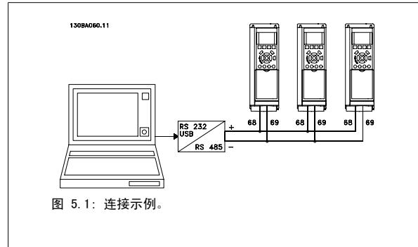
为了避免屏蔽丝网中出现电势均衡电流，请通过端子 61 (该端子经过 RC 回路同机架连接) 将电缆屏蔽丝网接地。
