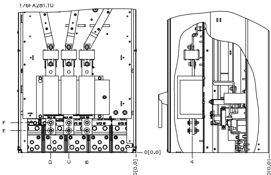
图 3.21：IP00 机箱的断路开关的电源接头位置
