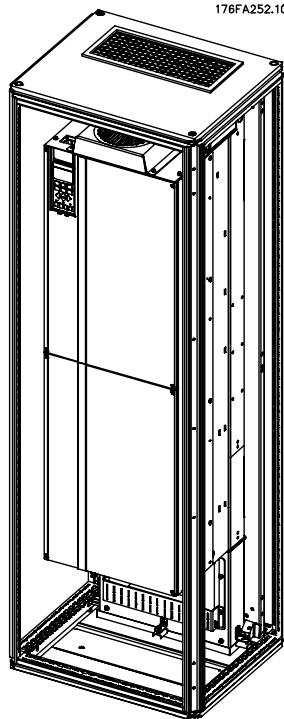
图 3.38：在 Rittal TS8 机箱中安装 IP00
