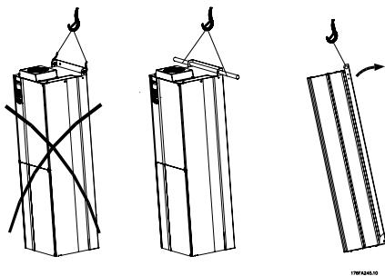
图 3.3: 机架规格 D 和 E 的建议起吊方法。
