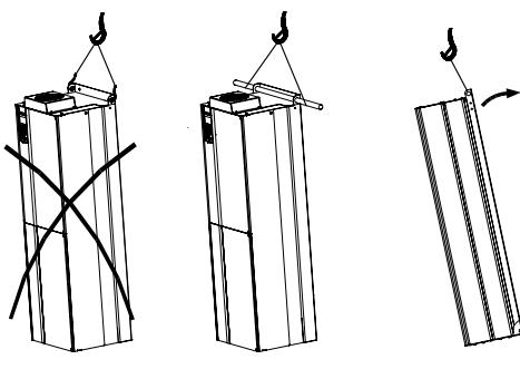
图 3.34：将变频器安装在墙面上时的起吊方法
