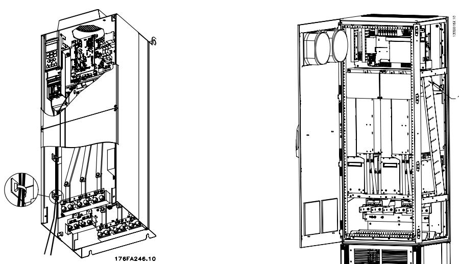
D3 的控制卡接线路径。D1、D2、D4、E1 和 E2 的控制卡接线路径与此相同。F1/F3 的控制卡接线路径。F2/F4 的控制卡接线路径与此相同。
