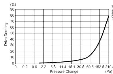
图 3.32: E 机架 的降容与 压力变化 (大风扇) P355T5-P450T5 和 P630T7-P560T7
