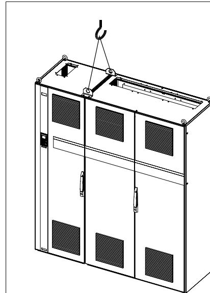
图 3.5: 建议起吊方法, 机架规格 F2。
