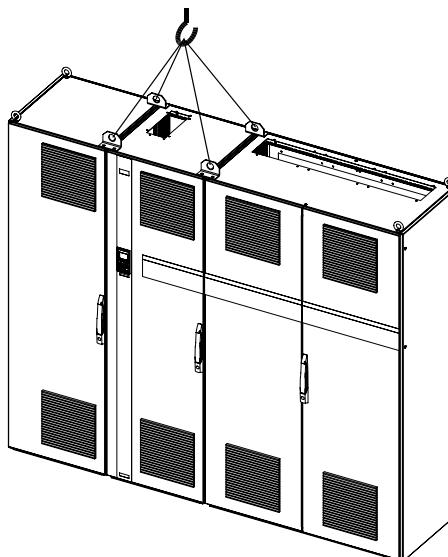
图 3.7: 建议起吊方法, 机架规格 F4。
