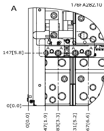
图 3.20: IP00 机箱 的电源接头位置
