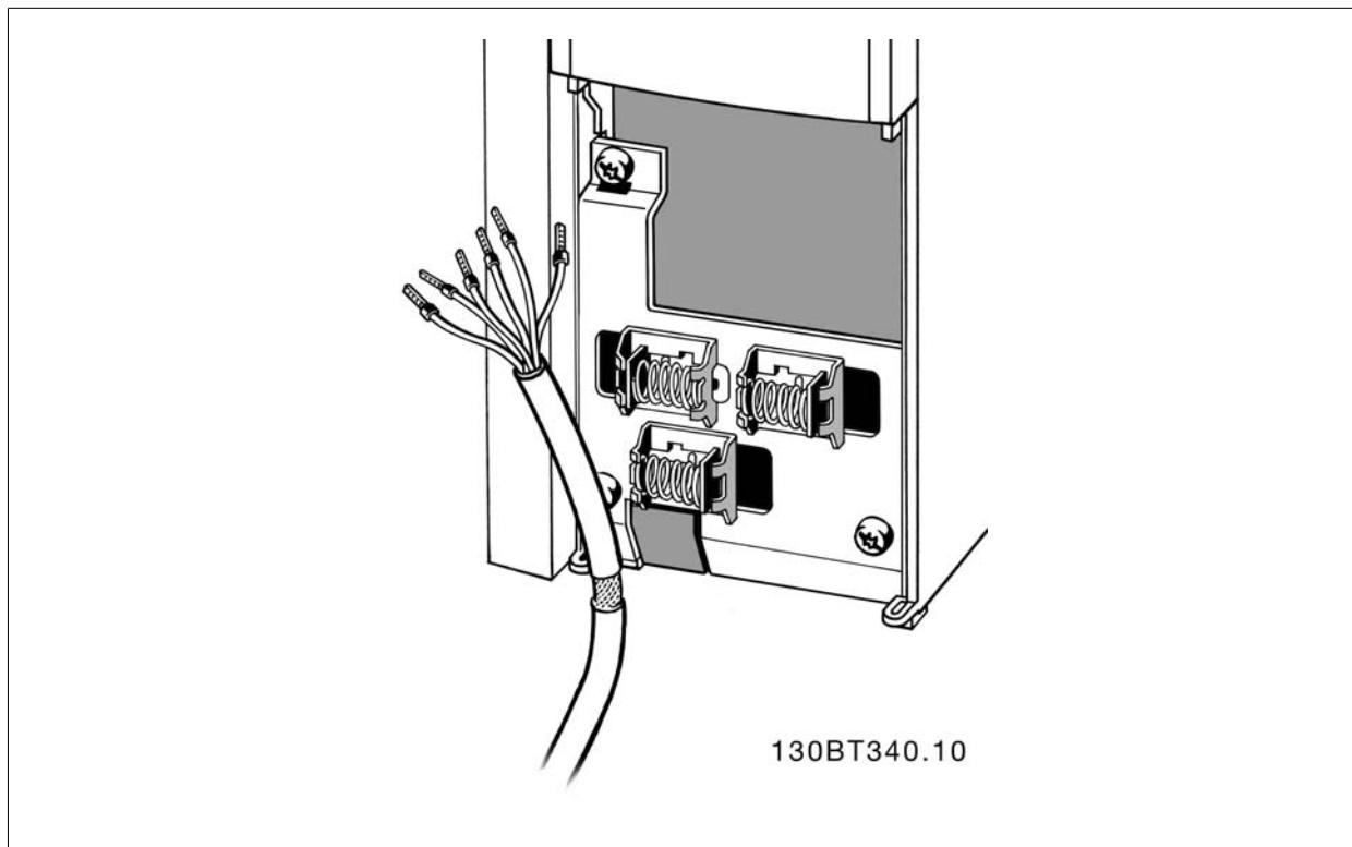
按照变频器操作说明的介绍连接这些电缆。记住用正确方式连接屏蔽层，以确保最理想的抗电气干扰能力。
