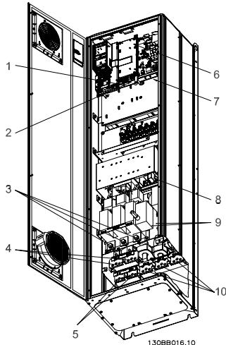
图 4.2: 紧凑型 IP 21 (NEMA 1) 和 IP 54 (NEMA 12)，带断路器、保险和射频干扰滤波器，机架规格 D2
