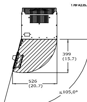
图 3.8: IP21/IP54 机箱类型, 机架规格 D1 和 D2 的前方空间。
