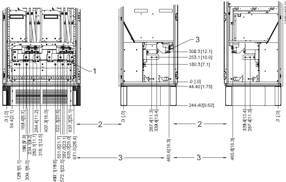
图 3.23: 端子位置 - 逆变器机柜 - F1 和 F3 (正、左和右视图)。密封板比 0 平面低 42 mm。
