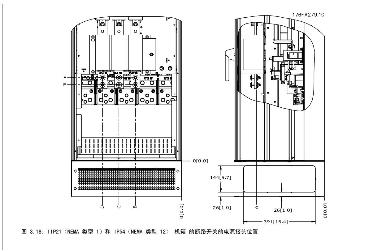
图 3.18: IIP21 (NEMA 类型 1) 和 IP54 (NEMA 类型 12) 机箱的断路开关的电源接头位置
