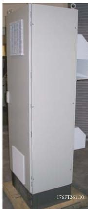
本節將說明變頻器 機架 D3、D4 與 E2 所提供之 NEMA 3R 套件的安裝方式。這些套件係針對位於 Rittal TS8 NEMA 3R 機架或 NEMA 4 外殼內的機架的 IP00/ 底架型號而設計與測試的。NEMA-3R 外殼可防水、防冰凍，並可於戶外使用。NEMA-4 外殼可更耐風吹雨打、防水並可於戶外使用。外殼的最小深度為 500 毫米 (E2 機架則為 600 毫米)，而套件係針對 600 毫米 (E2 機架則為 800 毫米) 寬的外殼而設計。亦可使用其他寬度的外殼，但需要配合使用額外的 Rittal 硬體。安裝時需要滿足最大深度與寬度的要求。
