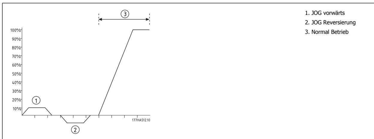
Die Aktivierung des JOG-Betriebs muss über einen programmierbaren Eingang erfolgen (Par. 3-3). Wenn während des JOG-Betriebs ein anderer Befehl empfangen wird, stoppt der Starter und wartet auf einen neuen Befehl.
