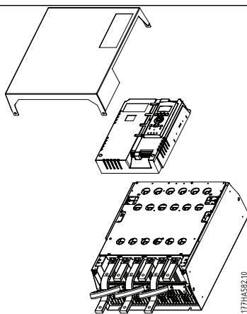
1. Uklonite sva ožičenja i veze sa soft startera pre rasklapanja uređaja.
