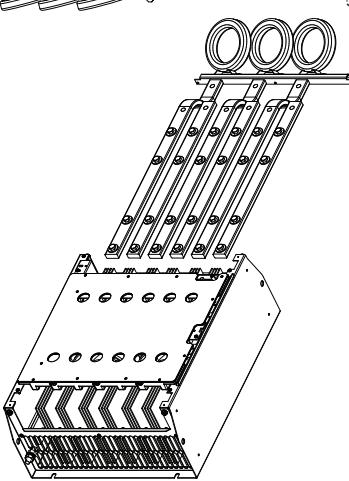
1. Uvucite spojnice kroz gornji deo startera. Za ulazne spojnice kratki uvjeni kraj treba da bude izvan startera. Za izlazne spojnice otvor bez navoja treba da bude izvan startera.
