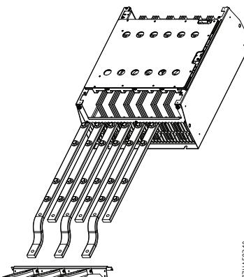
1. Odvijte i skinite magnetske ploče za premošćenje (SAMO modeli MCD5-0620C do MCD5-1600c).
