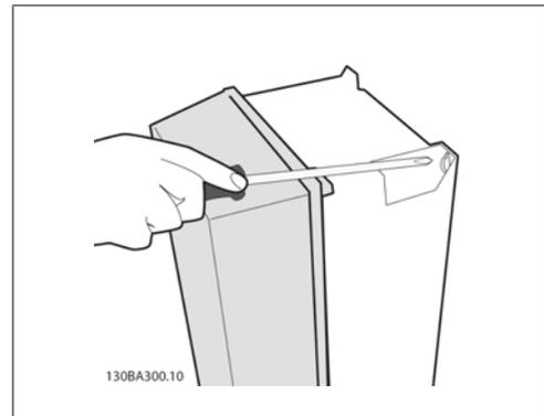
Ilustración 4.14: Tightening of screws
