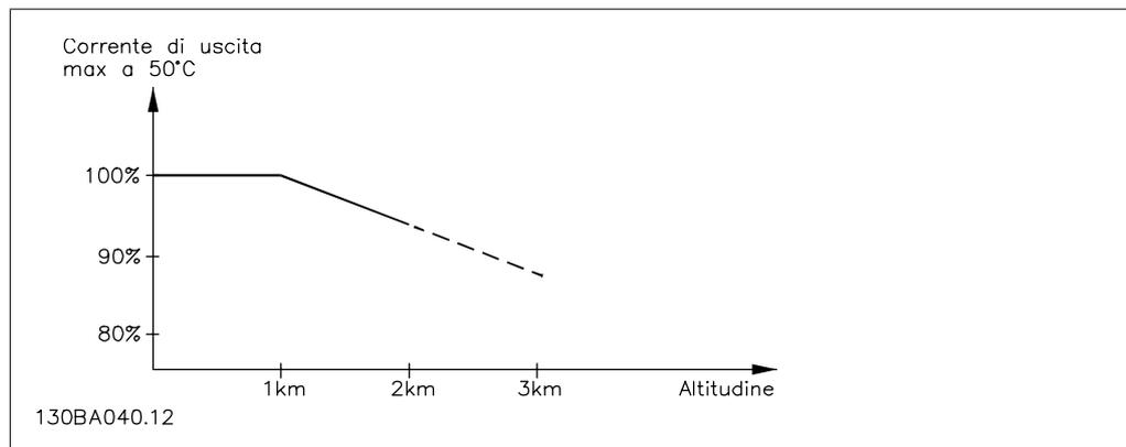
Disegno 9.9: Declassamento della corrente di uscita rispetto all'altitudine, con  $T_{AMB, MAX}$ . Per altitudini superiori ai 2 km, contattare Danfoss Drives riguardo alle disposizioni PELV.
