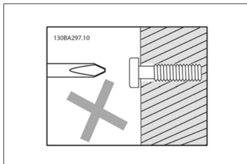
Disegno 4.12: Montaggio errato delle viti
