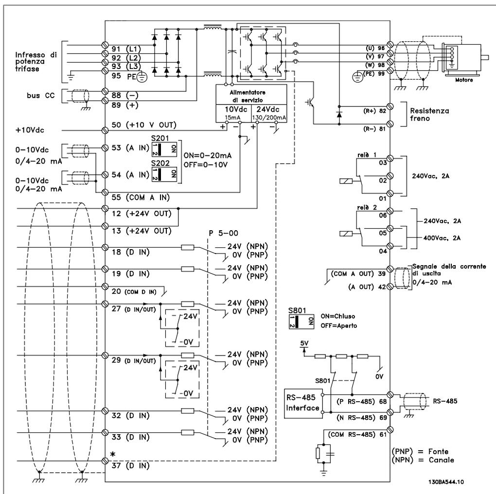
Disegno 5.28: Il diagramma mostra tutti i morsetti elettrici. (Il morsetto 37 è solo presente per unità con funzione di arresto di sicurezza).
