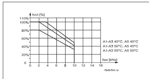
Disegno 9.2: Declassamento di  $I_{out}$  in base a diverse  $T_{AMB, MAX}$  per la custodia A utilizzando la SFAVM
