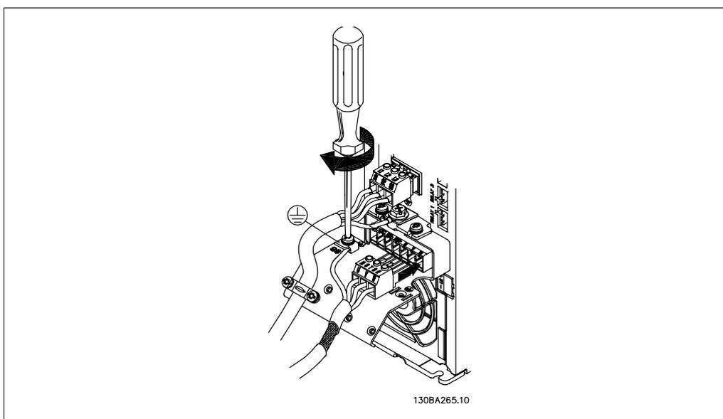
Disegno 5.11: Prima fissare il conduttore di terra del motore, quindi inserire i fili U, V e W del motore nei morsetti e serrarli.
