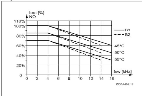
Disegno 9.5: Declassamento di  $I_{out}$  in base a diverse  $T_{AMB, MAX}$  per la custodia B utilizzando 60 PWM nel modo coppia normale (110% sovraccoppia)
