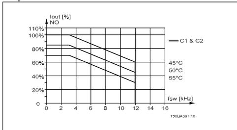
Disegno 9.7: Declassamento di  $I_{out}$  in base a diverse  $T_{AMB, MAX}$  per il custodia C utilizzando 60 PWM nel modo coppia normale (110% sovraccoppia)
