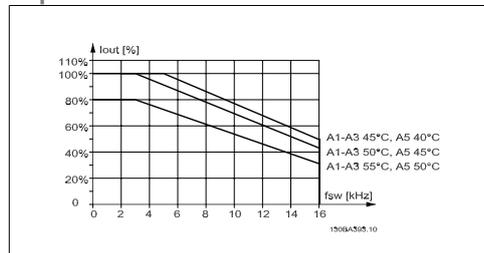
Disegno 9.1: Declassamento di  $I_{out}$  in base a diverse  $T_{AMB, MAX}$  per la custodia A utilizzando 60 PWM
