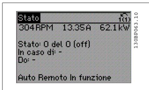
La **sezione inferiore** visualizza sempre lo stato del convertitore di frequenza nella modalità Stato.
