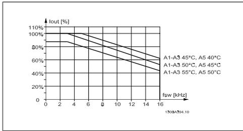
Disegno 9.3: Declassamento di  $I_{out}$  in base a diverse  $T_{AMB, MAX}$  per la custodia A utilizzando 60 PWM e un cavo motore lungo al massimo 10 m
