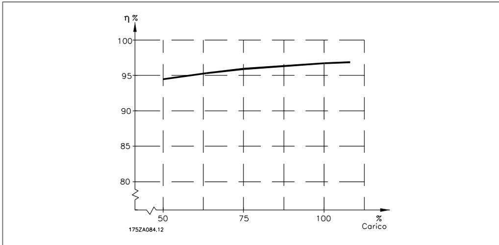
In base al grafico sopra riportato, è possibile calcolare le prestazioni del sistema a velocità differenti.
