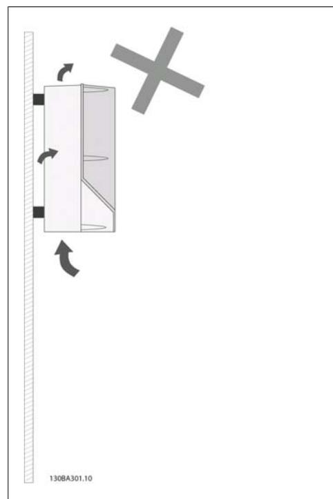
Disegno 4.3: Non montare unità con custodie diverse da A2 e A3 come mostrato senza pannello posteriore - il raffreddamento è insufficiente e la durata in servizio può essere ridotta drasticamente.
