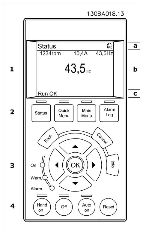
Viene visualizzata la programmazione attiva (selezionata come Setup attivo nel par. 0-10). Se si programma un setup diverso da quello attivo, il numero del setup appare sulla destra fra parentesi durante la programmazione.
