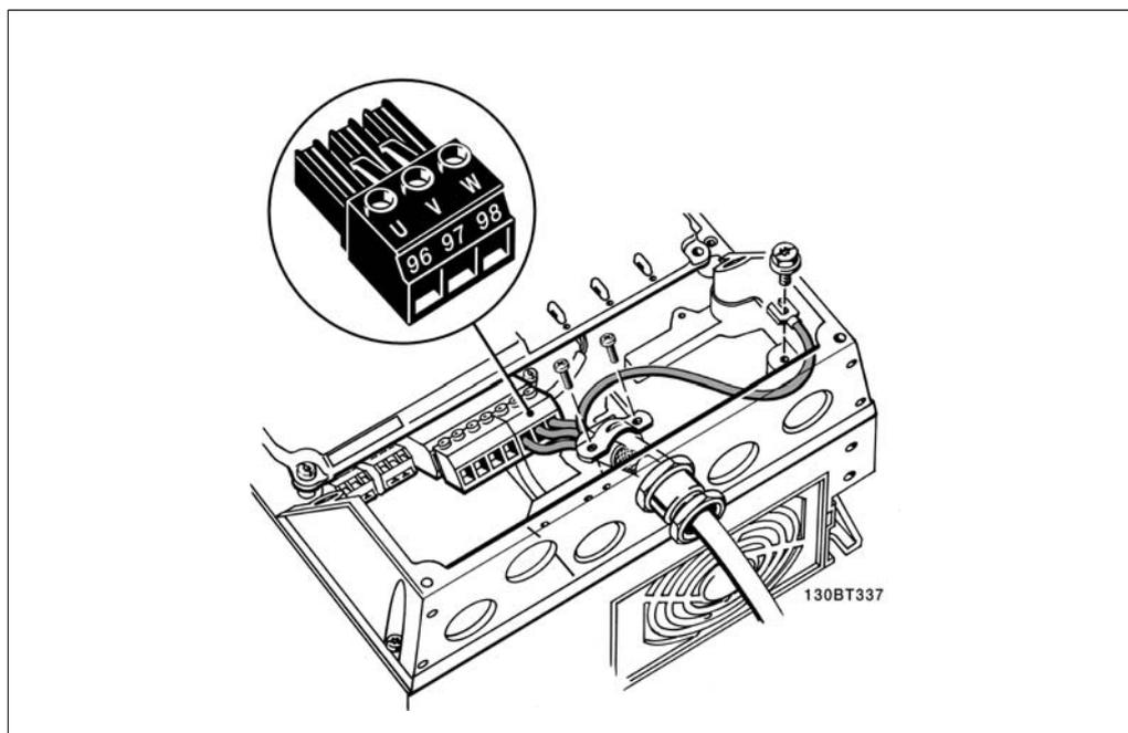
Disegno 5.13: Prima fissare il conduttore di terra del motore, quindi inserire i fili U, V e W del motore nel morsetto e serrarli. Assicurare che l'isolamento esterno del cavo motore viene rimosso sotto il pressacavo EMC.
