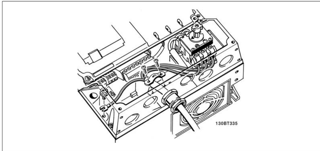
Disegno 5.7: Collegamento alla rete e messa a terra con sezionatore di rete.
