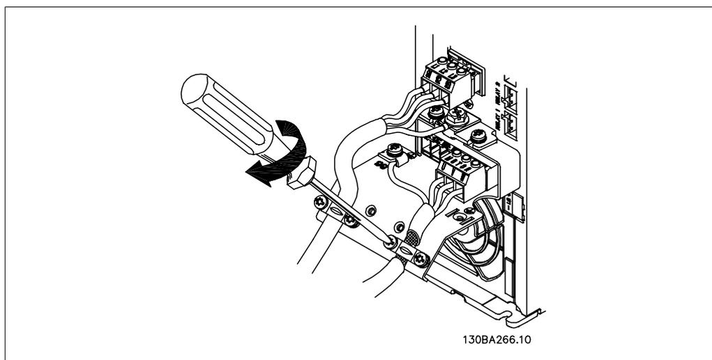
Disegno 5.12: Montare il pressacavo per assicurare una connessione a 360 gradi tra telaio e schermo; notare che l'isolamento esterno del cavo motore viene rimosso sotto il morsetto.
