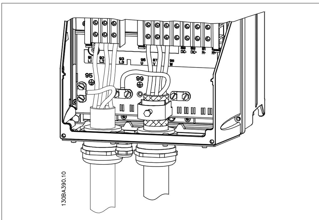
Disegno 5.15: Prima fissare il conduttore di terra del motore, quindi inserire i fili U, V e W del motore nel morsetto e serrarli. Assicurare che l'isolamento esterno del cavo motore viene rimosso sotto il pressacavo EMC.
