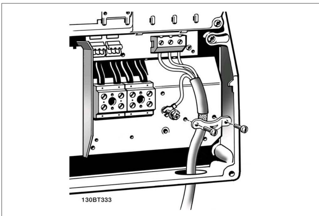
Disegno 5.14: Prima fissare il conduttore di terra del motore, quindi inserire i fili U, V e W del motore nel morsetto e serrarli. Assicurare che l'isolamento esterno del cavo motore viene rimosso sotto il pressacavo EMC.
