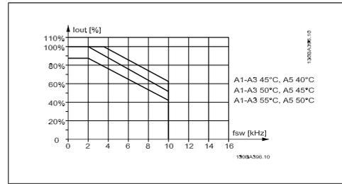
Disegno 9.4: Declassamento di  $I_{out}$  in base a diverse  $T_{AMB, MAX}$  per il custodia A utilizzando il SFAVM e un cavo motore lungo al massimo 10 m
