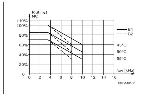
Disegno 9.6: Declassamento di  $I_{out}$  in base a diverse  $T_{AMB, MAX}$  per la custodia B utilizzando SFAVM nel modo coppia normale (110% sovraccoppia)
