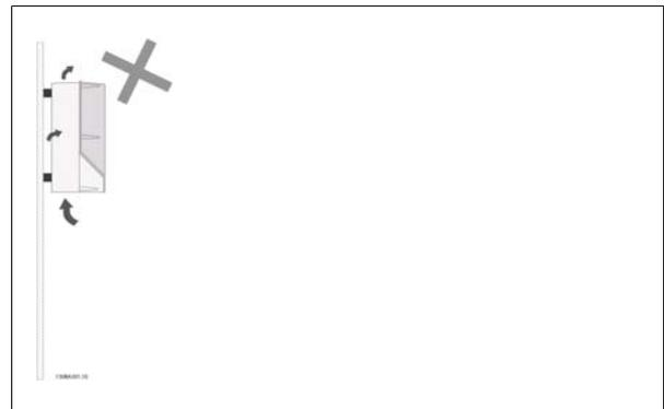
Abbildung 4.3: Befestigen Sie die Geräte nicht wie abgebildet ohne Rückplatte (außer bei A2- und A3-Gehäuse). In diesem Fall ist die Kühlung unzureichend, und die Lebensdauer kann sich drastisch reduzieren.
