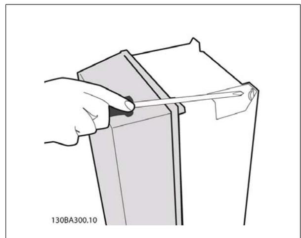
Abbildung 4.14: Anziehen der Schrauben
