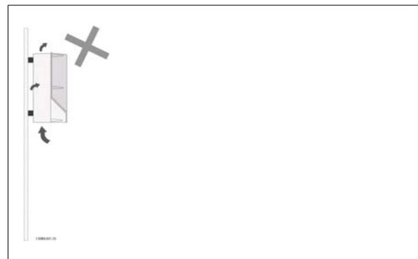
Illustration 4.3: Ne pas monter les unités autres que A2 et A3 sans plaque arrière (comme indiqué) car le refroidissement est insuffisant et la durée de vie peut être considérablement réduite.
