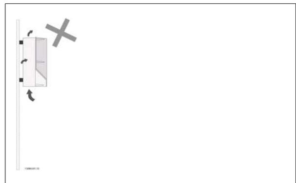
Disegno 4.3: Non montare unità con custodie diverse da A2 e A3 come mostrato senza pannello posteriore - il raffreddamento è insufficiente e la durata in servizio può essere ridotta drasticamente.
