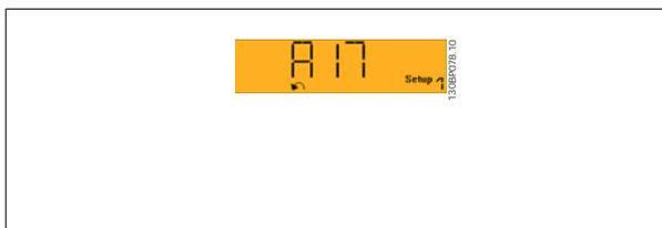
Ilustração 6.3: Exemplo de exibição de alarme
