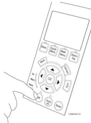
Ilustração 5.53: Passo 8: Pressione o botão [Off] para parar o motor novamente.
