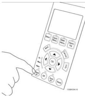
Ilustração 5.50: Passo 5: Ao apertar o botão, o LED do botão deve estar aceso e o motor poderá funcionar.
