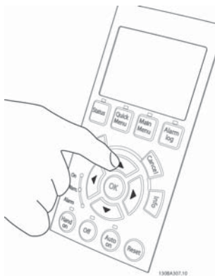
Ilustração 5.51: Passo 6: A velocidade do motor pode ser conferida no LCP. Ela pode ser ajustada acionando os botões para cima ▲ e para baixo ▼.
