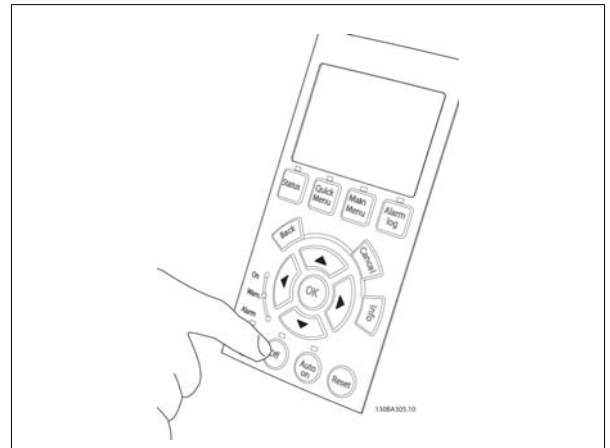
图 5.53: 步骤 8: 按 [Off] (停止) 按钮再次使电动机停止。
