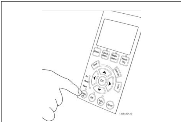
图 5.50: 步骤 5: 按 [Hand on] (手动启动) 按钮。该按钮上的指示灯应亮起, 电动机可能会旋转。
