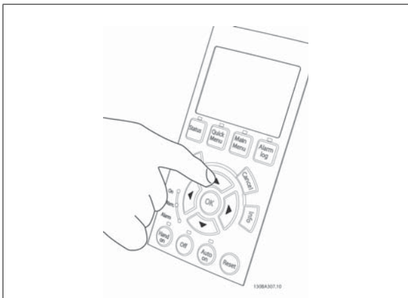
图 5.51: 步骤 6: 电动机的速度可在 LCP 上看到。按向上 (▲) 和向下 (▼) 箭头按钮可以调整速度。
