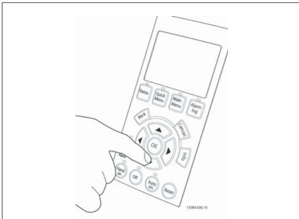
图 5.52: 步骤 7: 要移动光标, 请使用向左 (◀) 和向右 (▶) 箭头按钮。这样可以大幅度改变速度。
