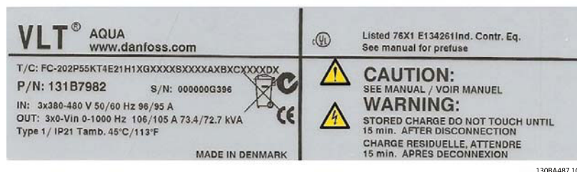
Obrázek 3.1: V tomto příkladu je uveden identifikační štítek měniče VLT AQUA Drive.
