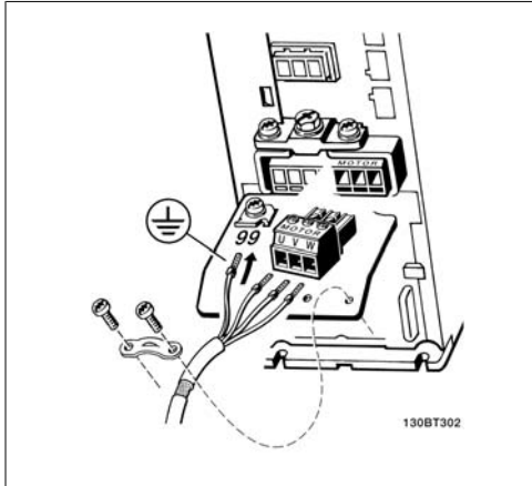
Kuva 5.8: Moottorin kytkentä A2- ja A3-kotelointeihin
