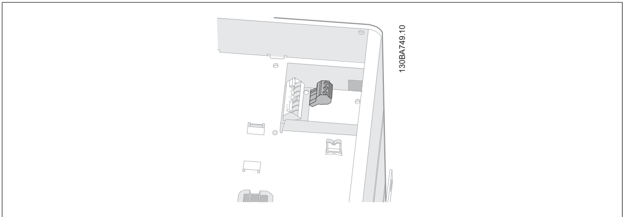
Abbildung 5.23: Klemmen für Relaisanschluss C3 und C4. Befinden sich in der oberen rechten Ecke des Frequenzumrichters.
