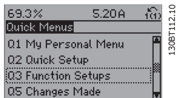
Afbeelding 1.9: Stap 3: gebruik de navigatietoetsen omhoog/omlaag om naar Functiesetups te schuiven. Druk op [OK].
