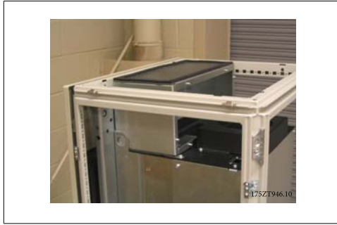
Abbildung 3.46: Montierte obere Lüftungsbaugruppe
