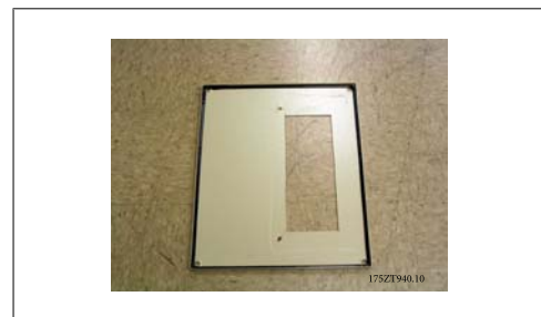
Abbildung 3.40: Rittal-Schaltschrank-Dachblech mit ausgeschnittener Öffnung Dachblech des Rittal-Standardschaltschranks ist ausgeschnitten. Dichtung wird im Ausschnitt nicht verwendet. Die Dichtung ist Teil der Lüftungskomponenten.
