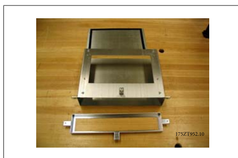
Afbeelding 3.52: Onderste luchtkanaal gedeeltelijk in elkaar gezet
