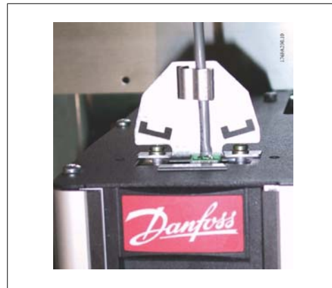
图 3.69: 从顶部连接现场总线。
