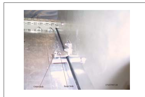
图 3.58: 将外孔中的安装螺钉移放到内孔中
