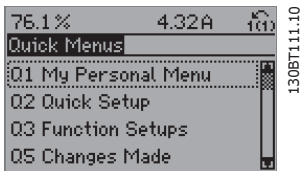
Illustration 5.3: Étape 2 : appuyer sur la touche [Quick Menus] (les choix du menu rapide apparaissent).
