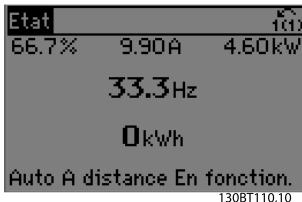
Illustration 5.2: Étape 1 : mettre le variateur de fréquence sous tension (voyant ON allumé).
