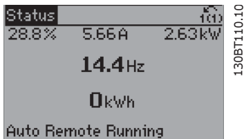
Ilustración 5.2: Paso 1: Encienda el convertidor de frecuencia (el LED se ilumina)
