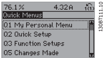
Ilustración 5.3: Paso 2: Pulse el botón [Quick Menus] (aparecen las opciones de los Menús rápidos).
