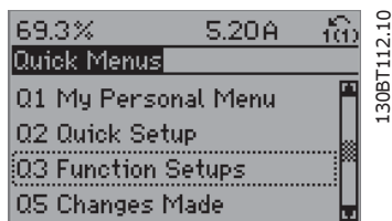
Afbeelding 5.4: Stap 3: gebruik de navigatietoetsen omhoog/omlaag om naar Functiesetups te schuiven. Druk op [OK].
