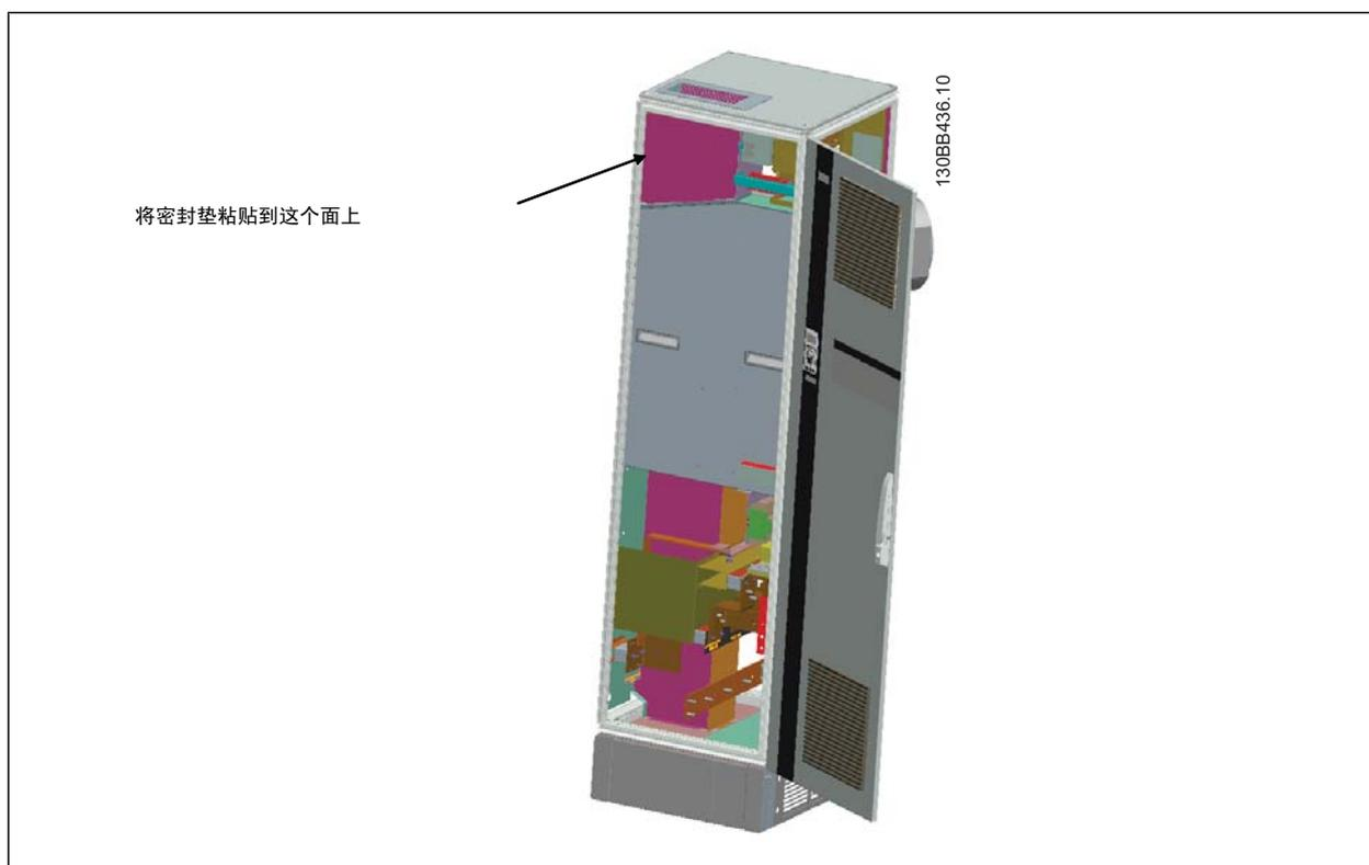
4. 打开滤波器 LCL 侧（最右侧机柜）的柜门，取下所示护罩。
