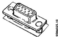
Панель LCP 2 может быть подключена к разъему Sub D на плате управления. Номер для заказа: 175N0131.
