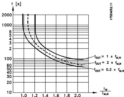
Функции ЭТР 1-4 не начинают вычислять нагрузку до тех пор, пока не произойдет переключения на набор, в котором они были выбраны. Это означает, что можно использовать функцию ЭТР даже при переключении между двумя и более двигателями.
