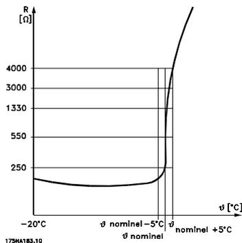
Если в двигателе предусмотрено термореле Klixon, оно также может быть подключено к входу. Если двигатели включены параллельно, то термисторы/термореле могут быть включены последовательно (полное сопротивление должно быть меньше 3 кОм).
