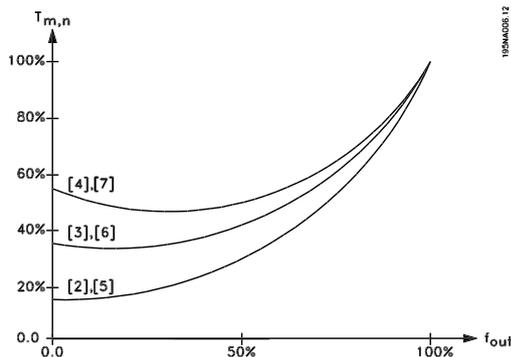
Если для согласования с используемым двигателем требуется специальная настройка отношения  $U/f$ , то следует выбрать режим *Специальный режим двигателя* [8]. Точки излома устанавливаются параметрами 423-428 *Напряжение/частота*.
