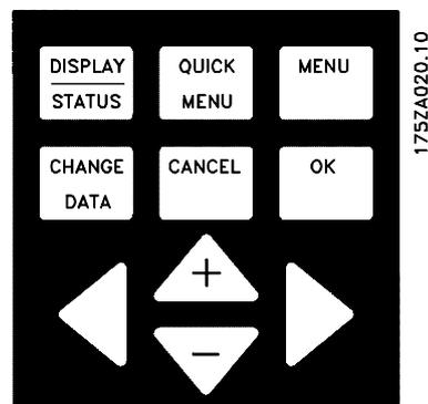
**[DISPLAY/STATUS]** dient zur Wahl der Anzeigart oder zum Zurückkehren in den Displaymodus aus dem Schnellmenü oder Menümodus.
