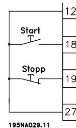
*Pulsstart*, wird mindestens 14 ms ein Impuls angelegt, so startet der Frequenzumrichter den Motor, sofern kein Stoppbefehl gegeben wurde. Der Motor kann durch kurzes Aktivieren von *Stopp invers* angehalten werden.
