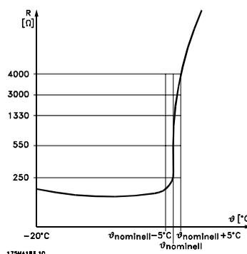
Wenn ein Motor statt dessen einen Klixon-Thermoschalter hat, kann dieser ebenfalls am Eingang angeschlossen werden. Bei parallel geschalteten Motoren müssen die Thermistoren/Thermoschalter in Serie geschaltet werden (Gesamtwiderstand unter 3 kΩ). Parameter 128 *Thermischer Motorschutz* muss für *Thermistorwarnung* [1] oder *Thermistorauslösung* [2] programmiert und der Thermistor zwischen einem Digitaleingang und Klemme 50 (Versorgungsspannung + 10 V) angeschlossen werden.
