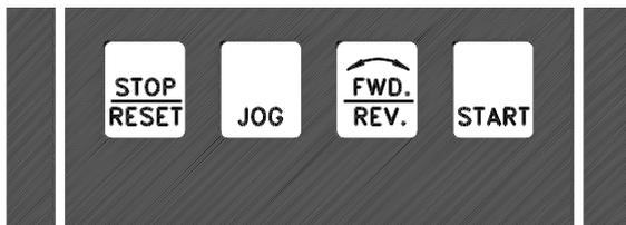
**[STOP/RESET]** dient zum Anhalten des angeschlossenen Motors oder zum Quittieren (Reset) des Frequenzumrichters nach einer Störung. Kann über Parameter 014 *Ort Festsdrehzahl* aktiv oder inaktiv gewählt werden.
