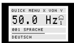
In der untersten Zeile werden Parameternummer und -name sowie Status bzw. Wert des ersten Parameters des Schnellmenüs angezeigt. Beim ersten Drücken der [QUICK MENU] Taste nach dem Einschalten des Geräts beginnt die Anzeige immer an Pos. 1 - siehe nachstehende Tabelle.
