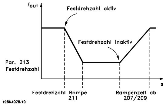
Die Rampenzeit Festdrehzahl beginnt mit der Aktivierung der Festdrehzahl über das Bedienfeld, einen der digitalen Eingänge bzw. die serielle Schnittstelle.
