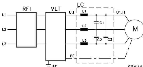
Wenn ein Motor über einen Frequenzumrichter betrieben wird, sind manchmal Störgeräusche vom Motor zu hören. Diese konstruktionsbedingten Geräusche des Motors werden jedesmal erzeugt, wenn die Wechselrichterkontakte im Frequenzumrichter aktiviert werden. Die Frequenz der Störgeräusche entspricht somit der Anschlussfrequenz des Frequenzumrichters.
