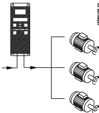
Der Frequenzumrichter kann mehrere parallel geschaltete Motoren steuern. Wenn die Motoren verschiedene Drehzahlen haben sollen, müssen Motoren mit unterschiedlichen Nenndrehzahlen eingesetzt werden. Da sich die Drehzahl der Motoren gleichzeitig ändert, bleibt jeweils das Verhältnis zwischen den Nenndrehzahlen im gesamten Bereich gleich. Der Gesamtstromverbrauch der Motoren darf den maximalen Ausgangsnennstrom  $I_{INV}$  des Frequenzumrichters nicht übersteigen.
