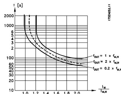
Die ETR-Funktionen 1-4 beginnen erst mit der Lastermittlung, wenn auf die entsprechende Satzanwahl umgeschaltet wird. Dies bedeutet, dass die ETR-Funktion auch beim Wechsel zwischen zwei oder mehreren Motoren verwendet werden kann.
