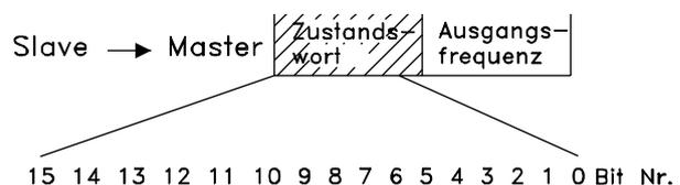
Das Zustandswort dient dazu, einem Master (z.B. einem PC) den Zustand eines Slave (Frequenzumrichters) mitzuteilen. Slave•Master
