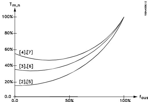
Spezielles *M*otordrehmoment [8] ist zu wählen, wenn eine spezielle *U/f*-Kennlinie zur Anpassung an einen gegebenen Motor gewünscht wird. Die Eckwerte werden in den Parametern 423–428 *Spannung/Frequenz* eingestellt.
