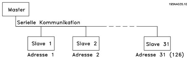
Alle Frequenzumrichter verfügen serienmäßig über eine RS 485-Schnittstelle, die die Wahl zwischen zwei Protokollen ermöglicht. Die beiden in Parameter 512 *Telegrammprofil* wählbaren Protokolle sind:
