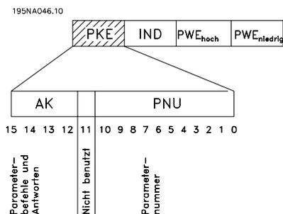
Die Bits Nr. 12-15 dienen zur Übertragung von Parameterbefehlen vom Master zum Slave und den vom Slave bearbeiteten Rückantworten zurück zum Master.
