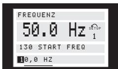
Die gewählte Ziffer wird blinkend angezeigt. In der untersten Zeile des Displays wird der Datenwert angezeigt, der bei Quittierung mit [OK] eingelesen (gespeichert) wird.
