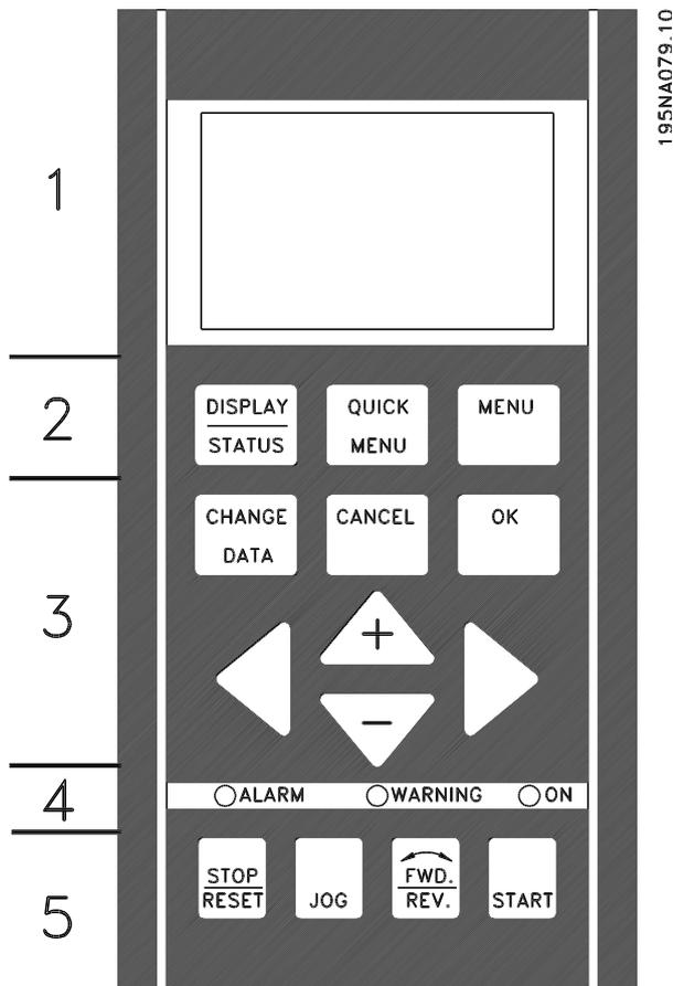
Der VLT 2800 kann mit einer Bedieneinheit (LCP 2) verbunden werden, die eine vollständige Schnittstelle für Betrieb und Programmierung des Frequenzumrichters darstellt. Die Bedieneinheit LCP 2 kann bis zu drei Meter vom Frequenzumrichter entfernt aufgestellt werden, z.B. auf einer Frontplatte unter Verwendung des Zubehörsatzes.
