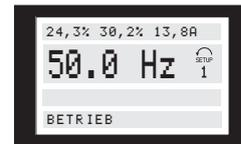
In diesem Zustand werden alle Datenwerte für vier Betriebsvariablen mit den zugehörigen Einheiten angezeigt, siehe Tabelle. Im Beispiel wurde diese Wahl getroffen: *Frequenz, Sollwert, Drehmoment* and *Strom* als Anzeige in der ersten und zweiten Zeile.
