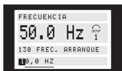
El dígito elegido destella. La línea inferior del display muestra el valor de dato que se introduce (guarda) al confirmarlo y salir con la tecla [**OK**].
