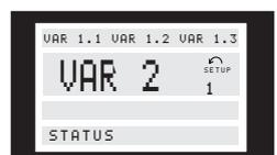
En el funcionamiento normal, es posible mostrar opcionalmente hasta 4 elementos de dato en el display de manera continua: 1,1; 1,2; 1,3 y 2. El estado de funcionamiento o las alarmas y advertencias generadas, se muestran en la línea 2 como una cifra numérica.
