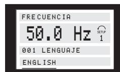
La línea inferior del display muestra el valor que se introduce (guarda) cuando se confirme pulsando la tecla [OK].
