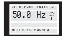
Aquí puede obtener la lectura del nombre de los parámetros y de la unidad en que se miden los datos de funcionamiento en la primera y segunda línea. La línea 2 del display no cambia.
