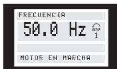
La línea 2 muestra el valor de un dato de funcionamiento en la unidad seleccionada, y la línea 1 contiene un texto que explica la línea 2. En el ejemplo, *Frecuencia* se ha seleccionado como lectura en el parámetro 009 *Lectura del display amplia*. En el funcionamiento normal, puede introducirse otra variable inmediatamente con las teclas [+ / -].
