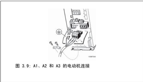
图 3.9: A1、A2 和 A3 的电动机连接
