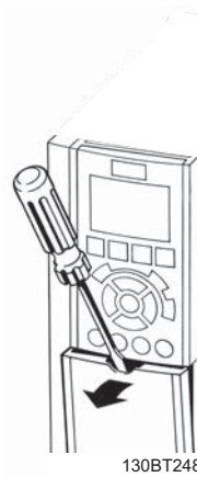
Ilustrasi 3.19: Jalan masuk penutup A2, A3, B3, B4, C3 dan C4 ke terminal kontrol
