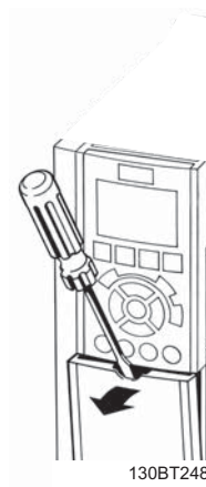
Ilustrasi 3.18: Jalan masuk penutup A2, A3, B3, B4, C3 dan C4 ke terminal kontrol
