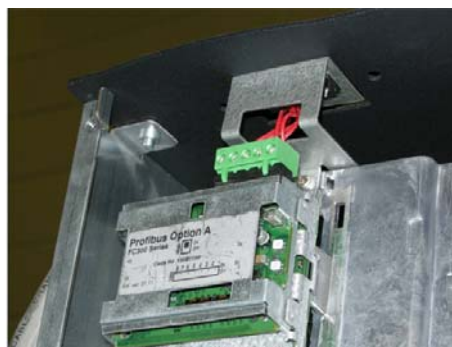
Abbildung 8.36: Anschluss von oben für Feldbus
