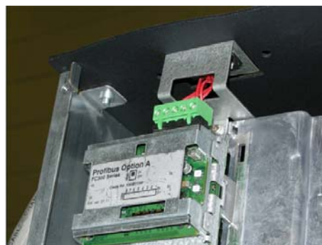
Bild 8.36: Toppanslutningen för fältbus.
