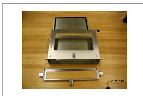
Illustration 3.52: Nedre rørledning delvist samlet
