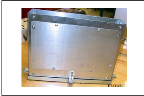
Illustration 3.53: Færdigsamlet nedre rørledning
