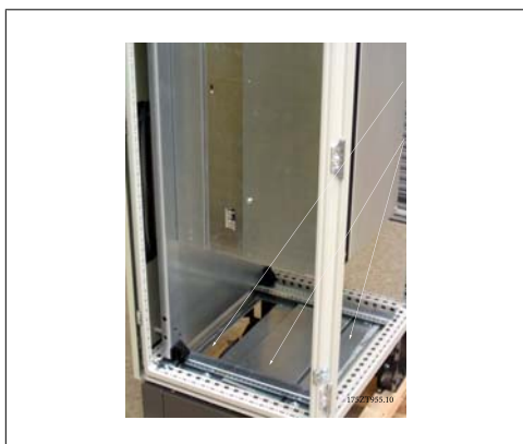
Illustration 3.55: Découpe inférieure de la protection
