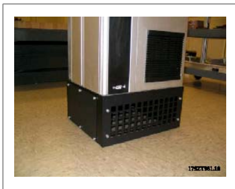
Bild 3.67: Ram D2 med piedestalen monterad
