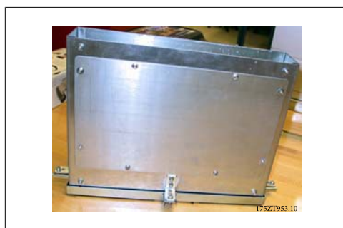
Afbeelding 3.53: Complete onderste luchtkanaal
