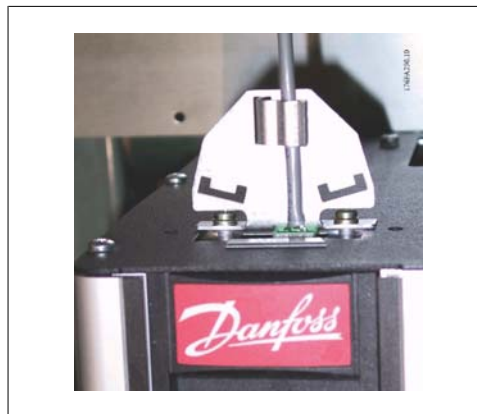
Afbeelding 3.69: Bovenaansluiting voor veldbus
