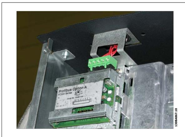
Ilustração 3.49: Conexão superior do fieldbus.
