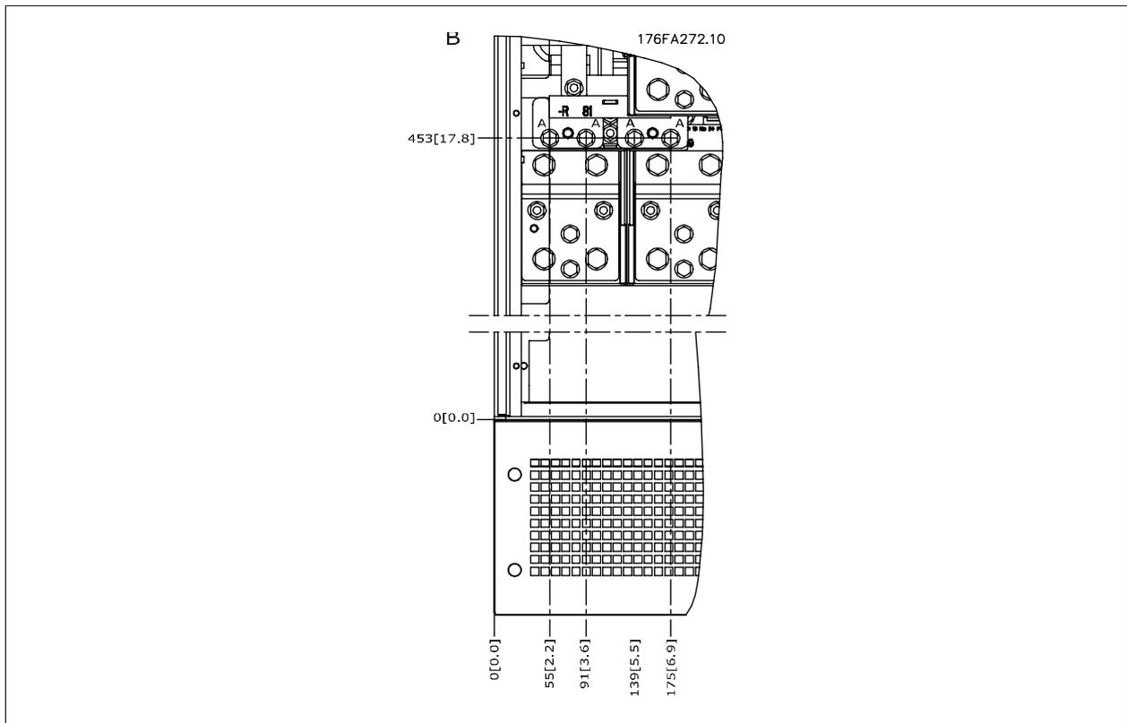
그림 3.13: IP21 (NEMA type 1) 및 IP54 (NEMA type 12) 외함의 전원 연결부 위치(B의 세부 그림)
