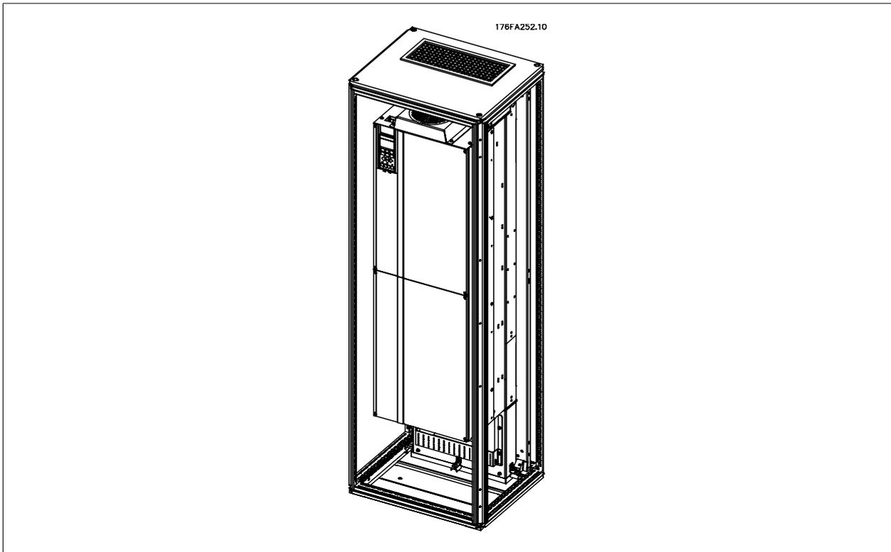
그림 3.27: Rittal TS8 외함에 IP00 설치
