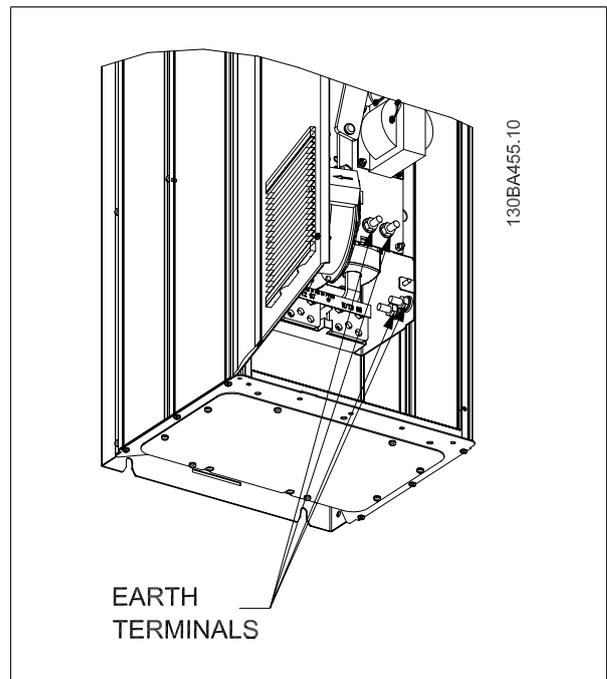
그림 3.37: IP21 (NEMA type 1) 및 IP54 (NEMA type 12)의 접지 단자 위치
