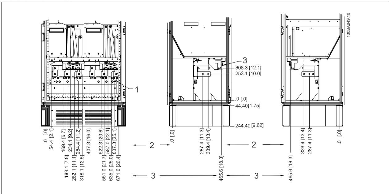
그림 3.19: 단자 위치 - 인버터 캐비닛 - F1 및 F3 (전면, 왼쪽 측면 및 오른쪽 측면 보기)
