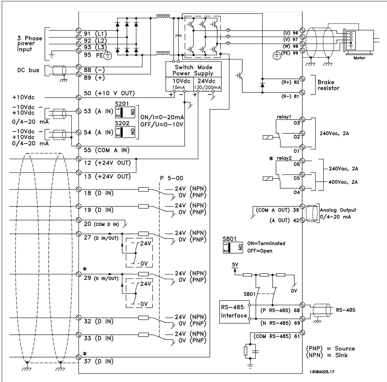
그림 3.50: 옵션을 제외한 모든 전기 단자를 나타내는 다이어그램.
