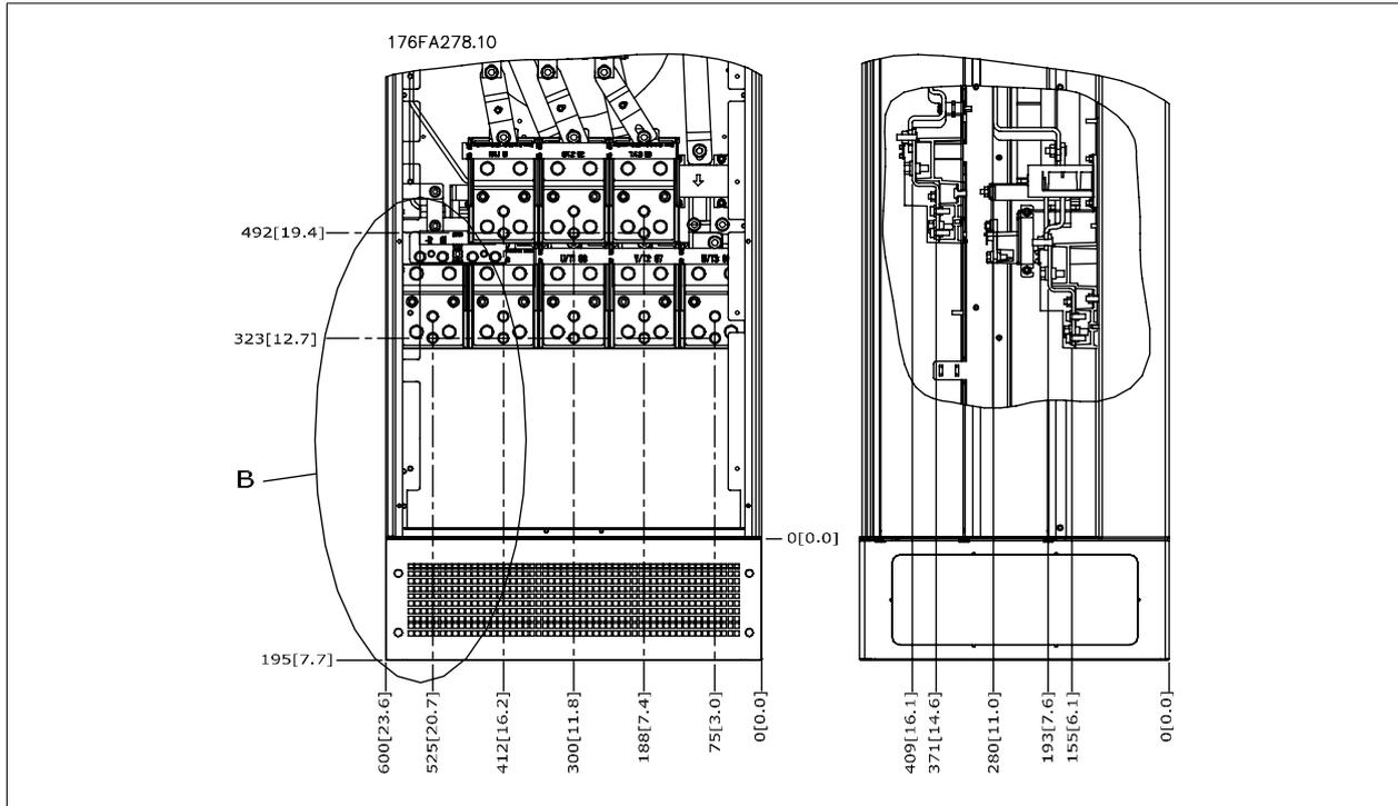
그림 3.12: IP21 (NEMA Type 1) 및 IP54 (NEMA Type 12) 외함의 전원 연결부 위치
