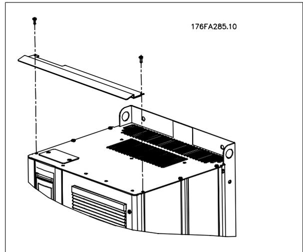
그림 3.26: 드립 쉴드(Drip shield) 설치.
