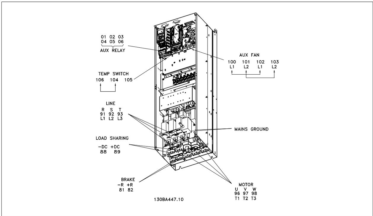
그림 3.35: 소형 IP 00 (새시) (차단기, 퓨즈 및 RFI 필터 포함), 외함 D4
