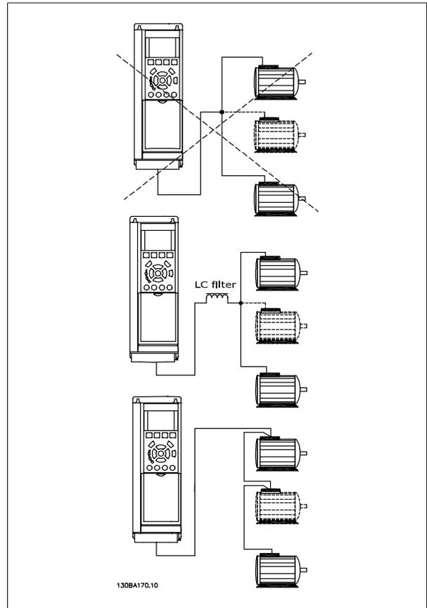
모터의 용량이 현저하게 차이가 날 경우에는 모터 기동 시와 낮은 RPM 범위에서 문제가 발생할 수 있습니다. 이는 모터 기동 시와 낮은 RPM 에서 상대적으로 큰 저항을 가진 소형 모터에 큰 전압이 인가되기 때문입니다.
