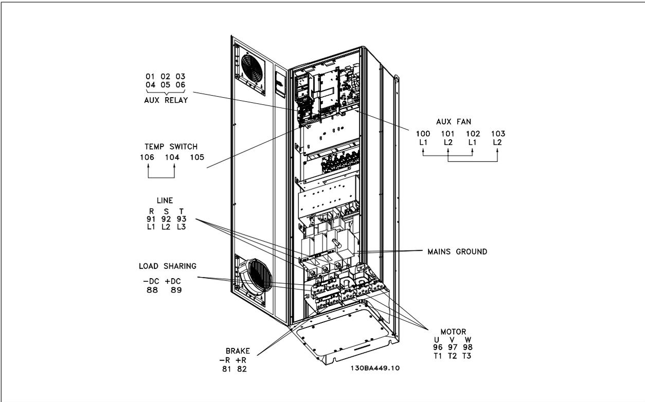
그림 3.33: 소형 IP 21 (NEMA 1) 및 IP 54 (NEMA 12) (차단기, 퓨즈 및 RFI 필터 포함), 외함 D2
