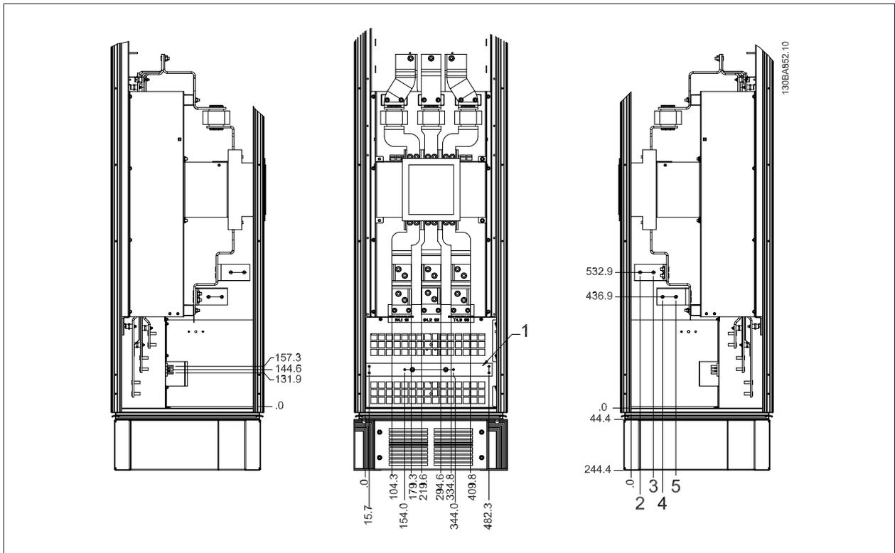
그림 3.23: 단자 위치 - 회로 차단기/ 일체형 스위치가 있는 옵션 캐비닛 (왼쪽 측면, 전면 및 오른쪽 측면 보기)
