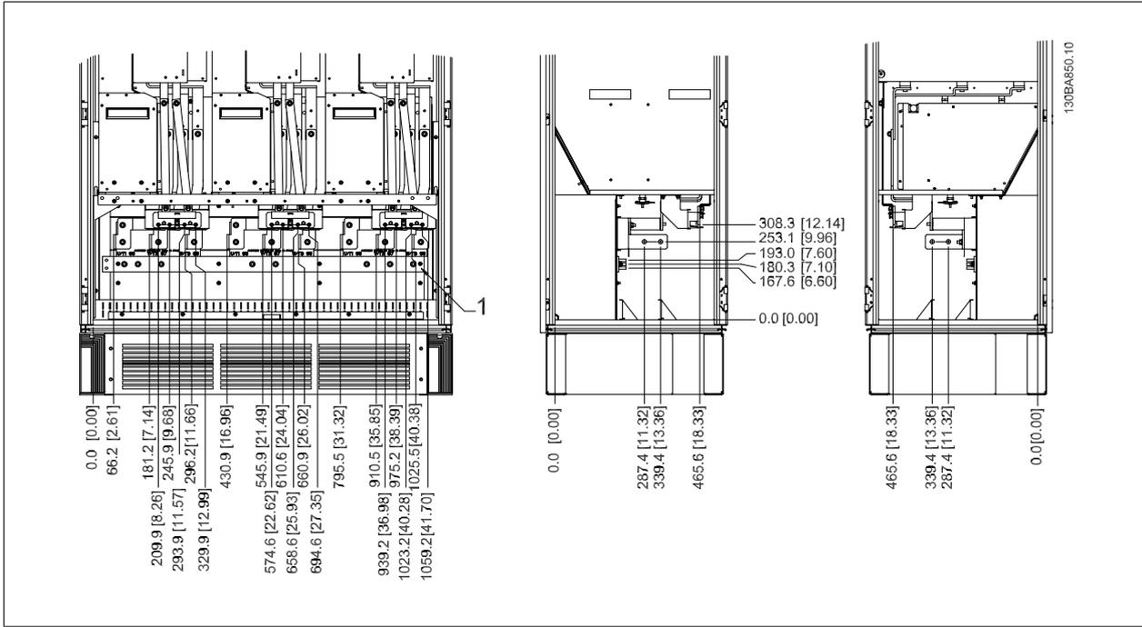
그림 3.20: 단자 위치 - 인버터 캐비닛 - F2 및 F4 (전면, 왼쪽 측면 및 오른쪽 측면 보기)
