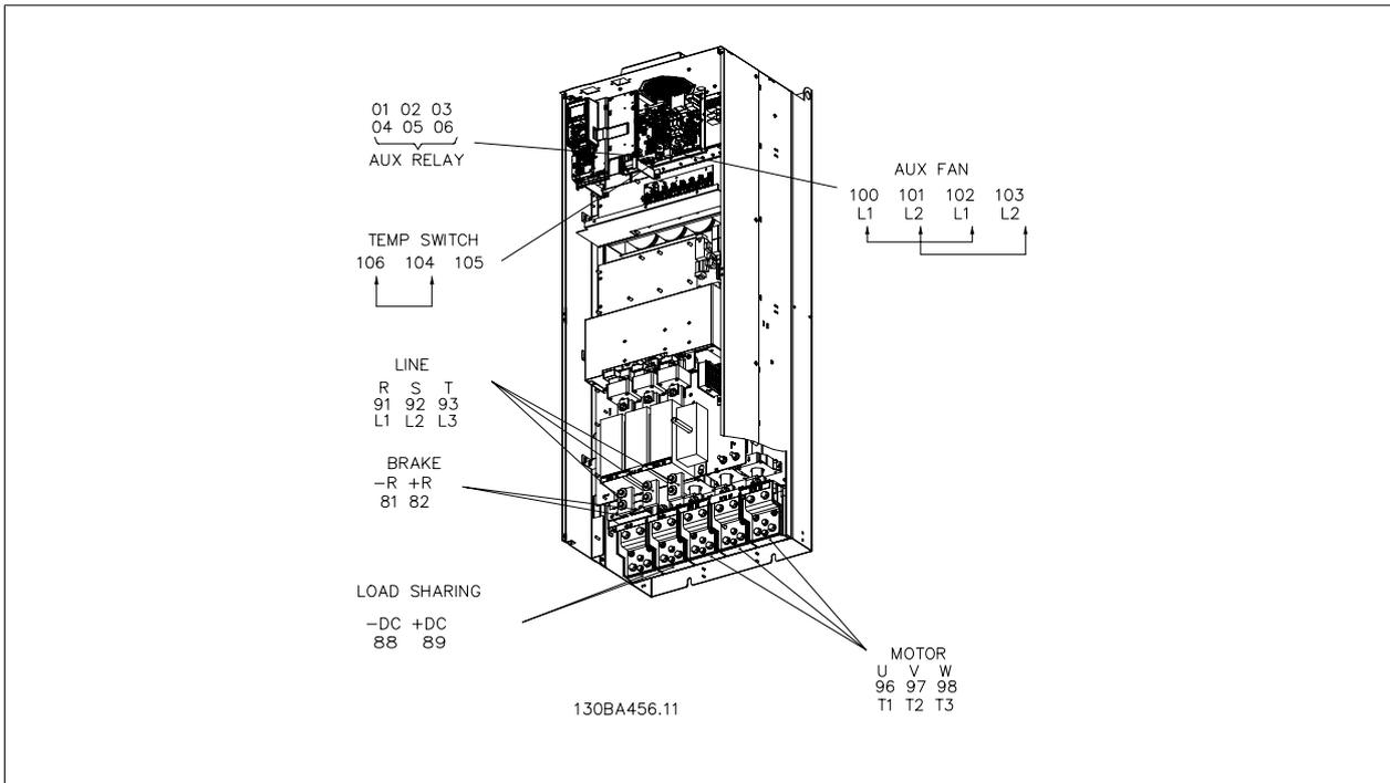
그림 3.39: 소형 IP 00 (새시) (차단기, 퓨즈 및 RFI 필터 포함), 외함 E2
