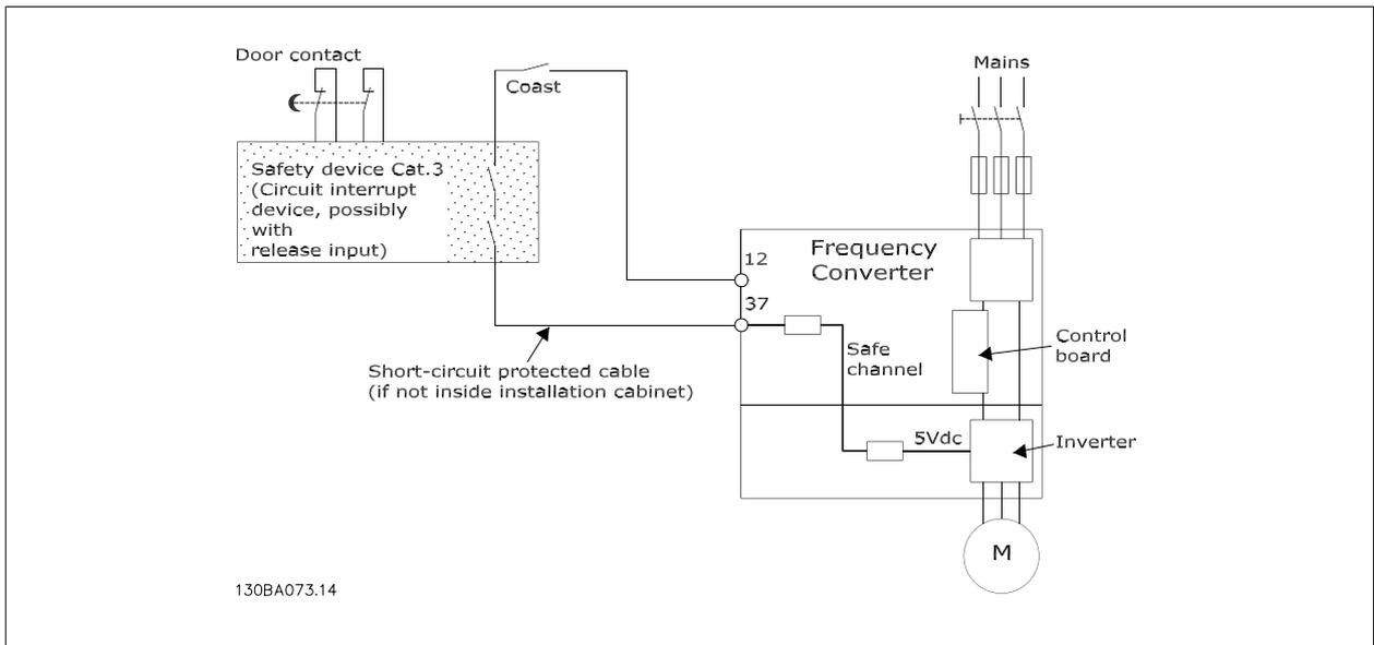
그림 2.2: 안전 부문 3(EN 954-1)에 의거, 정지 부문 0(EN 60204-1)을 만족시키기 위한 필수 요소를 나타내는 그림.
