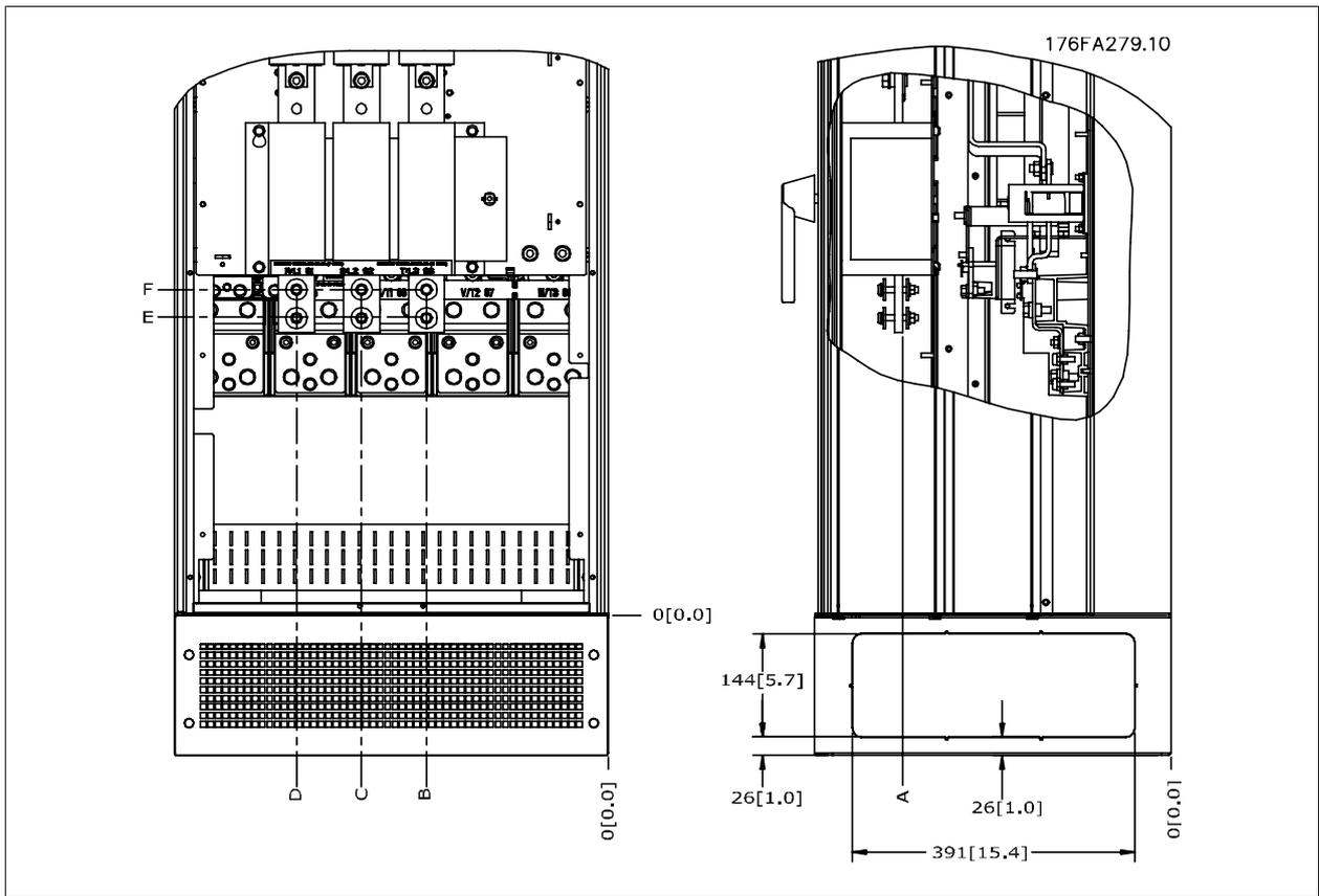
그림 3.14: IP21 (NEMA type 1) 및 IP54 (NEMA type 12) 외함 차단 스위치의 전원 연결부 위치
