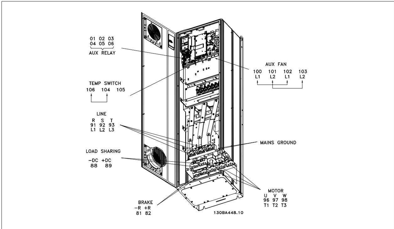
그림 3.32: 소형 IP 21 (NEMA 1) 및 IP 54 (NEMA 12), 외함 D1
