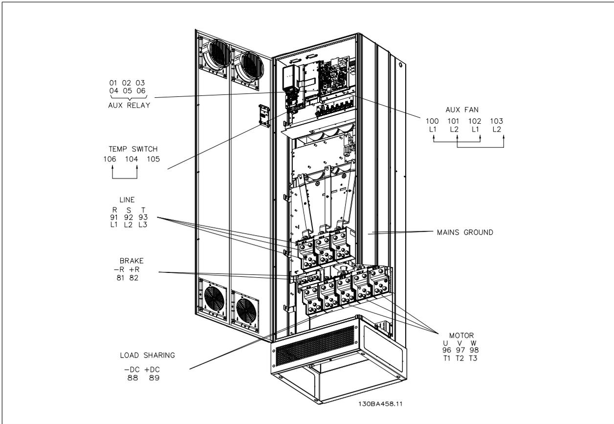
그림 3.38: 소형 IP 21 (NEMA 1) 및 IP 54 (NEMA 12), 외함 E1
