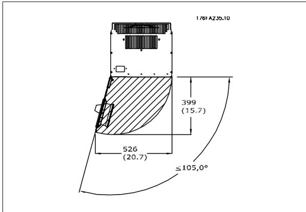
그림 3.8: IP21/IP54 외함 유형 D1 및 D2 전면의 여유 공간.
