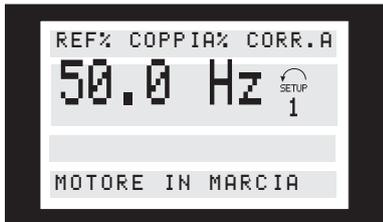
In questo stato i valori dato delle quattro variabili sono mostrati contemporaneamente con le relative unità di misura, vedi tabella. Nell'esempio, Riferimento, Coppia, Corrente e Frequenza vengono selezionati come variabili nella prima e nella seconda riga.
