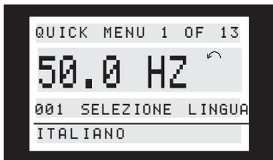
Nella parte inferiore del display, vengono indicati il numero e il nome del parametro insieme con lo stato/valore del primo parametro di Programmazione rapida. La prima volta che il tasto [QUICK MENU] è premuto dopo che l'unità è stata accesa, le letture iniziano sempre nella posizione 1 - vedi tabella sottostante.
