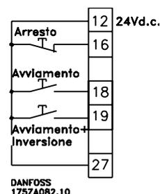
Avviamento su impulso - se viene fornito un impulso (min. 3 ms), il motore verrà avviato, a condizione che non sia stato impartito un comando di arresto (comando di funzionamento, gruppo 2). Il motore si arresta se viene azionato brevemente Arresto, comando attivo basso.
