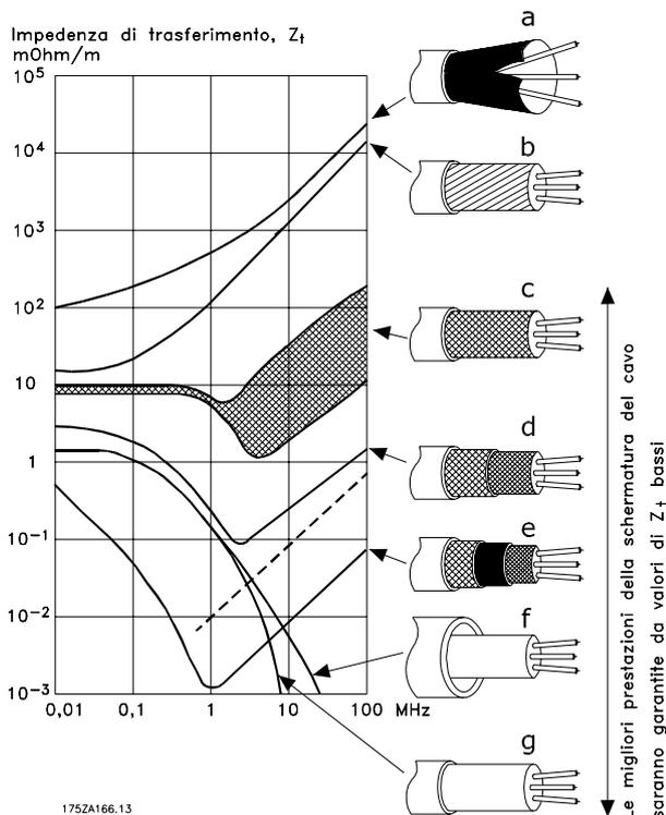
Anche se l'impedenza di trasferimento ( $Z_T$ ) viene specificata di rado dai produttori dei cavi, è spesso possibile stimarla ( $Z_T$ ) sulla base delle caratteristiche fisiche del cavo.
