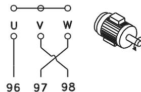
L'impostazione di fabbrica prevede una rotazione in senso orario se l'uscita del convertitore di frequenza è collegata come segue.
