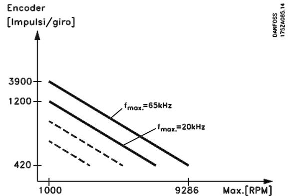
L'encoder usato deve essere del tipo Open Collector PNP 0/24 V CC (max. 20 kHz) o un accoppiamento in controfase 0/24 V CC (max. 65 kHz).
