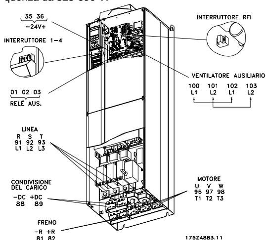
**Compatto IP 00 con sezionatore e fusibile**
