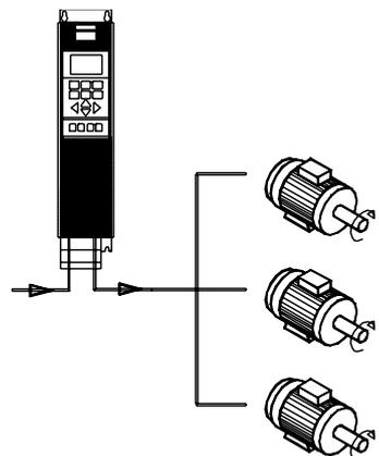
Il convertitore di frequenza è in grado di controllare diversi motori collegati in parallelo. Se i motori devono funzionare a regimi (giri/min) diversi, dovranno essere utilizzati motori con regimi nominali diversi (giri/min). I regimi dei motori vengono modificati contemporaneamente, vale a dire che il rapporto fra i regimi viene mantenuto per l'intero campo di funzionamento.
