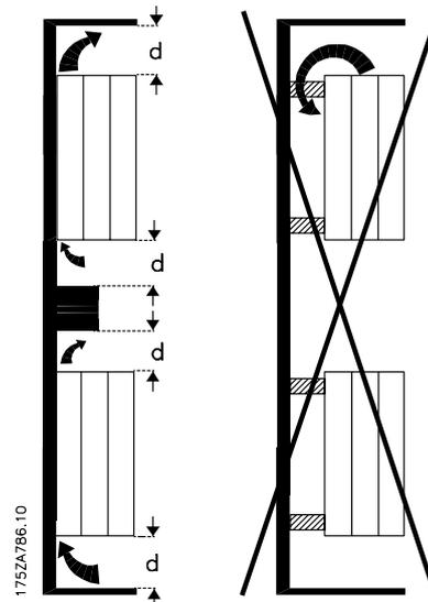
Alle Geräte im Buch- und Kompaktformat erfordern einen Mindestfreiraum über und unter dem Schutzgehäuse.
