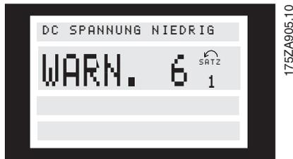
Bei Ausgabe eines Alarms wird die Störungsnummer in Zeile 2 angezeigt. In den Zeilen 3 und 4 des Displays wird eine Erläuterung angezeigt.
