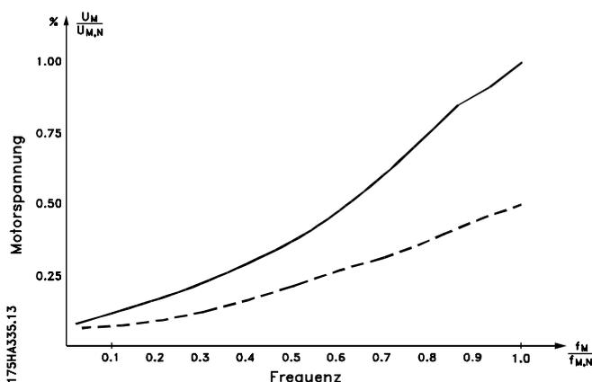
Wurde die AEO-Funktion in Parameter 101 *Konfiguration* ausgewählt, ist die Funktion permanent aktiv. Bei einer großen Abweichung vom optimalen U/f-Verhältnis stellt sich der VLT-Frequenzumrichter rasch selbst wieder ein.
