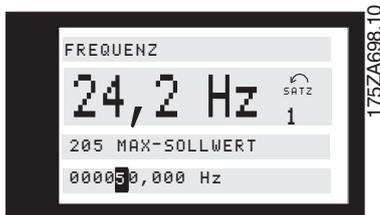
Die gewählte Ziffer wird durch einen blinkenden Cursor angezeigt. In der untersten Zeile des Displays wird der Datenwert angezeigt, der beim Quittieren durch Drücken von [OK] eingelesen (gespeichert) wird. Mit [CANCEL] kann das Ausführen der Änderung verhindert werden.
