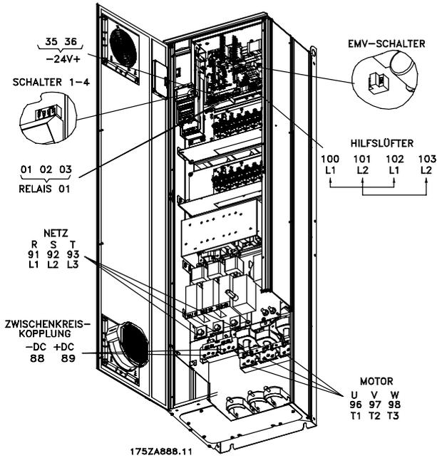
**IP54, IP21/NEMA 1 mit Trennschalter und Hauptsicherung**
