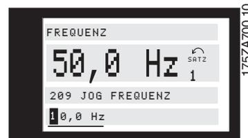
Die ausgewählte Ziffer blinkt. In der untersten Displayzeile wird der Datenwert angezeigt, der eingelesen (gespeichert) wird, wenn mit [OK] quittiert wird.
