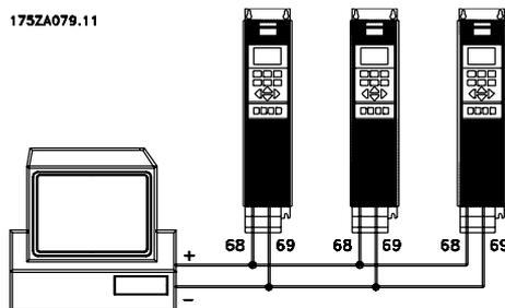
Afin d'éviter des courants d'égalisation de potentiel dans le blindage, celui-ci peut être mis à la terre via la borne 61 reliée au châssis par une liaison RC.
