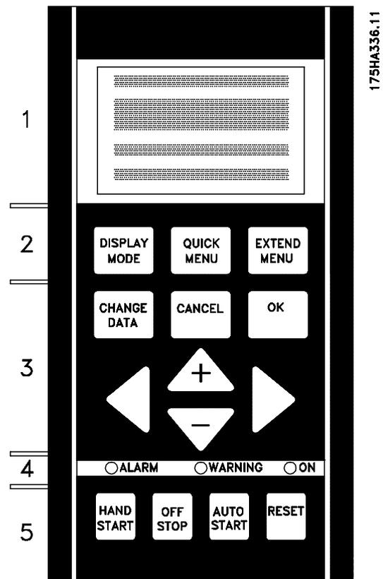
■ **Touches de commande pour la configuration des paramètres**
