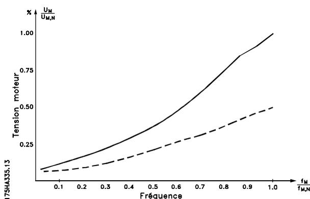
Si la fonction AEO a été sélectionnée au paramètre 101, *Caractéristiques du couple*, cette fonction sera active en permanence. S'il se produit une déviation importante par rapport au ratio U/f optimum, le variateur de vitesse VLT s'ajuste rapidement.
