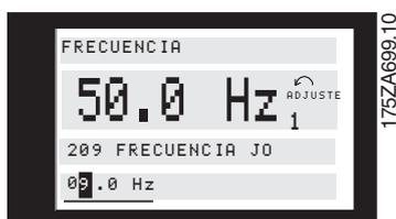
A continuación el dígito elegido se cambia de forma infinita mediante las teclas [+/-]:
