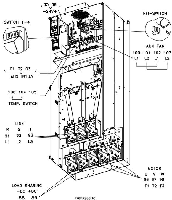
**Compact IP 00 sin sistema de desconexión ni fusible**
