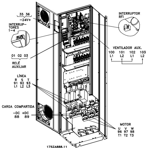
**IP 54, IP 21/NEMA 1 con sistema de desconexión y fusible principal**
