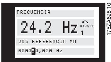
El dígito seleccionado se indica mediante un cursor parpadeante. La línea inferior de la pantalla muestra el valor de dato que se introduce (se guarda) cuando lo confirme pulsando el botón [OK]. Utilice [CANCEL] para cancelar el cambio.
