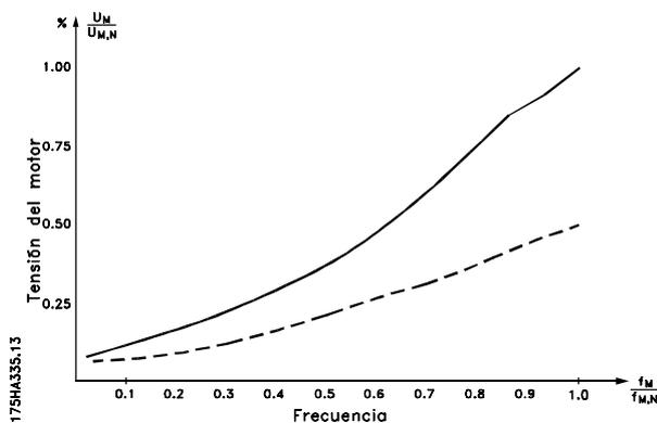
Si se ha seleccionado la función AEO en el parámetro 101, *Características de par*, esta función estará activa constantemente. Si se produce una desviación importante con respecto al índice U/f óptimo, el convertidor de frecuencia VLT se ajustará rápida y automáticamente.
