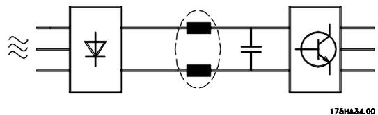
La distorsión de la tensión en la alimentación de la red depende del tamaño de la corriente de armónicos multiplicado por la impedancia interna de la red para la frecuencia dada. La distorsión de tensión total THD se calcula según los distintos armónicos de tensión usando la siguiente fórmula:
