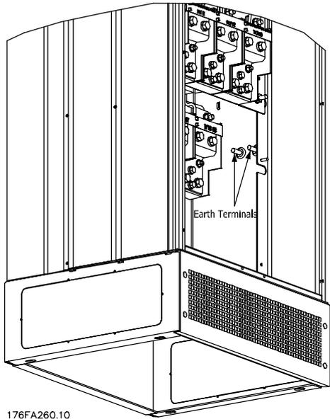
**Posición de terminales de conexión a tierra, IP
