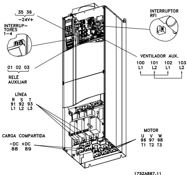
**IP 00 con sistema de desconexión y fusible**
