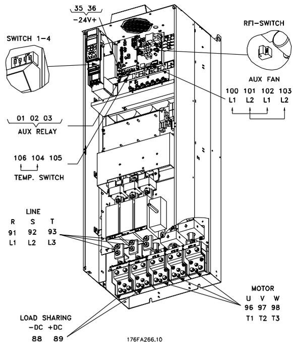
**Compact IP 00 con sistema de desconexión y fusible**
